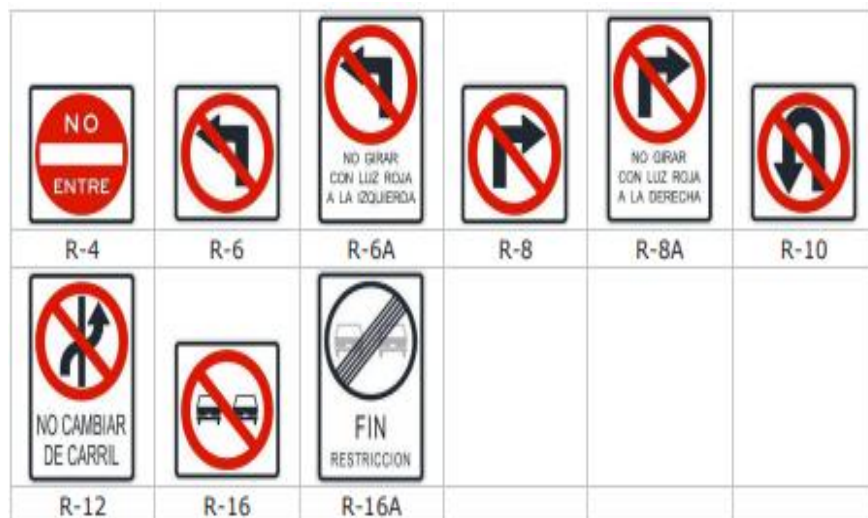
Figura N° 10: Señales de prohibición de maniobras y giros
