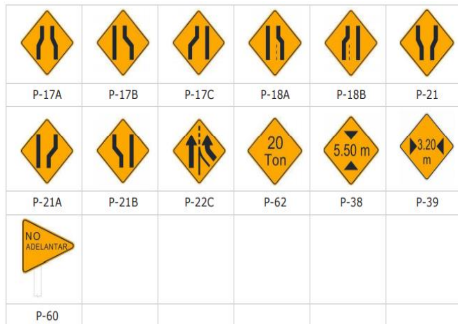
Figura N° 7: Señales preventivas por restricciones físicas de la vía
