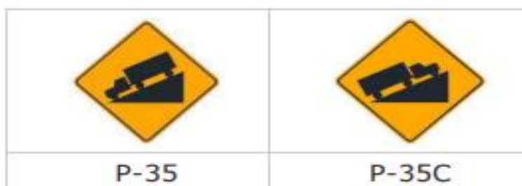
Figura N° 5: Señales preventivas – pendiente longitudinal
