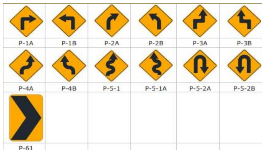
Figura N° 4: Señales preventivas – curvatura horizontal
