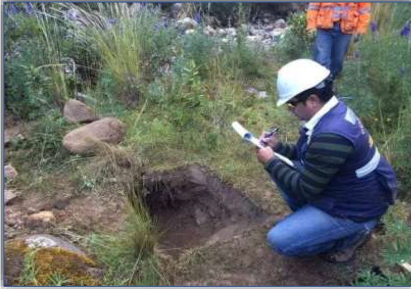
Figura N°20: pozo calicata. Fuente: Autor.
