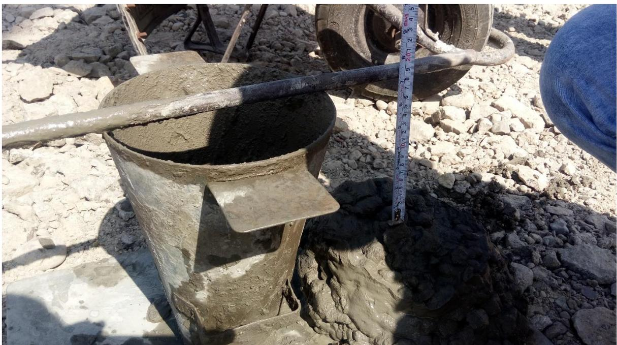
**Foto 04.** Medición del slump 7'' del concreto fresco con superplastificante.
