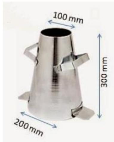
*Figura N° 04: Diseño del cono de Abrams.*
