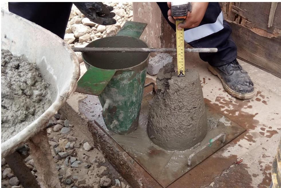
**Foto 02.** Medición del slump 3" del concreto fresco patrón.
