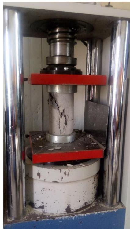
**Foto 07.** Ensayos de probetas cilíndricas a compresión.
