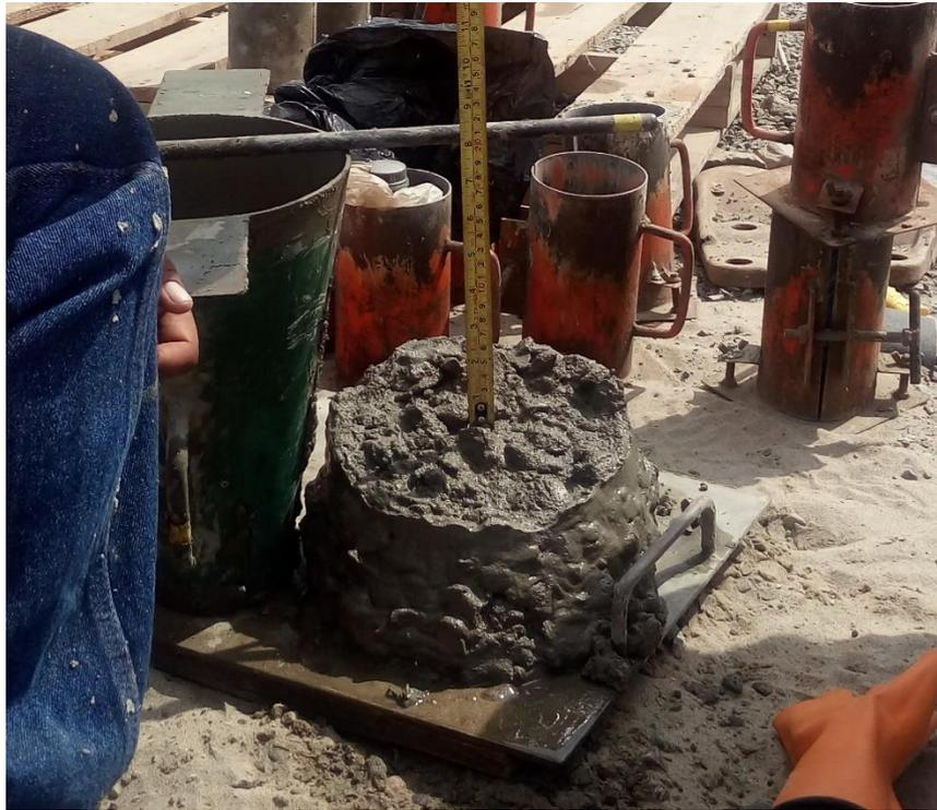
**Foto 04.** Medición del slump 8'' del concreto fresco con superplastificante.
