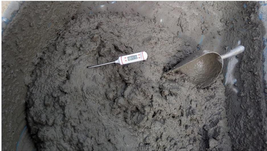
**Foto 01.** Medición de temperatura del concreto.
