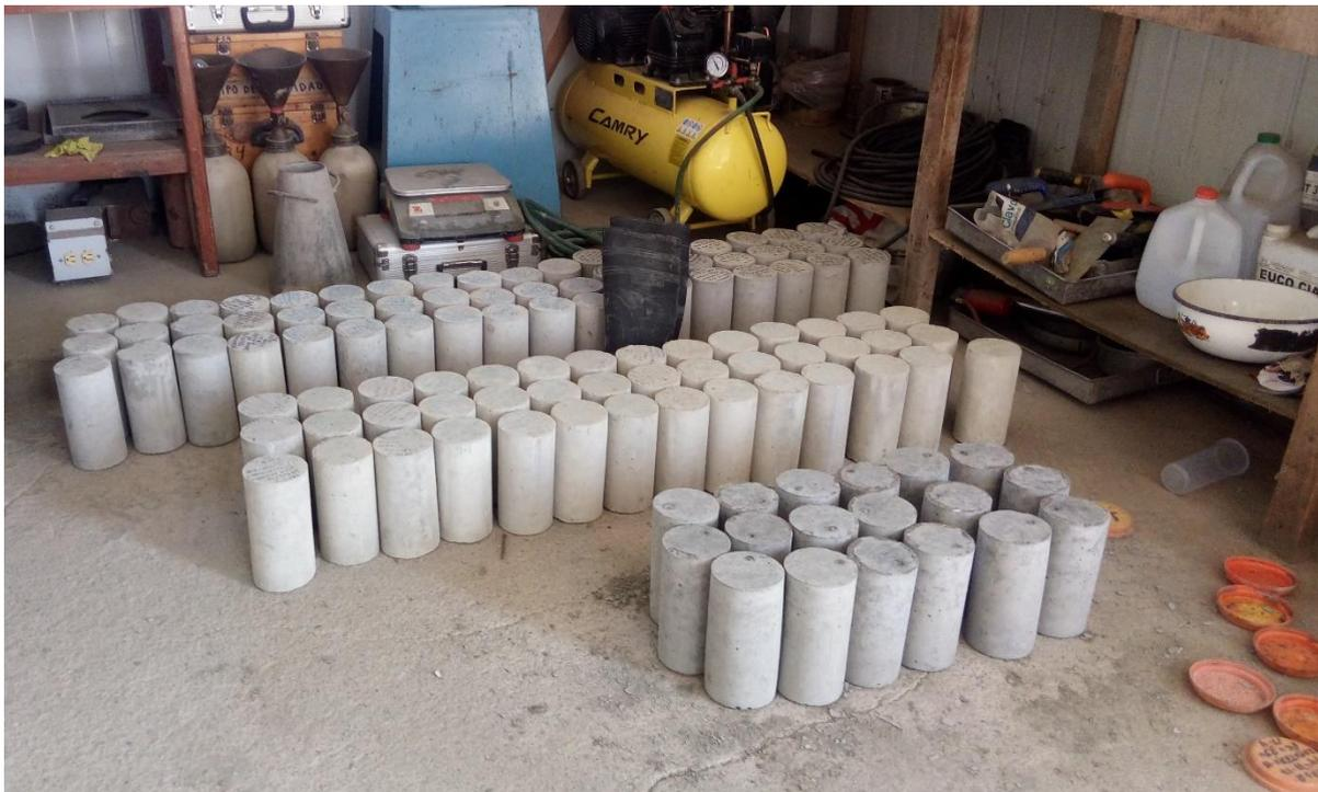
**Foto 05.** Probetas para ensayos a los 28 días.
