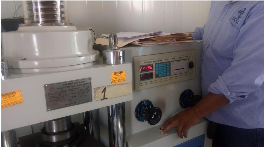
**Foto 06.** Equipo de compresión (prensa).
