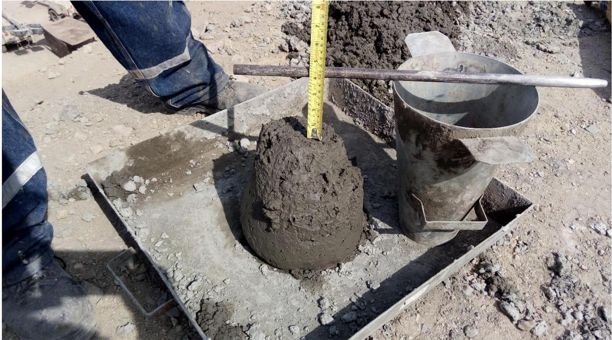
**Foto 03.** Medición del slump 4'' del concreto fresco patrón.
