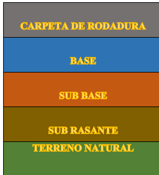
Figura 01. Elementos de un pavimento flexible.
