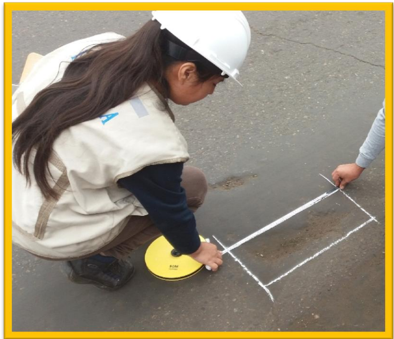
Figura 26: Tomando medidas de la falla huecos
