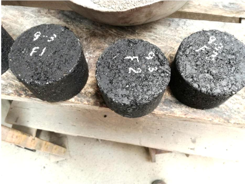
Imagen 11. Briquetas para para ensayos Marshall
