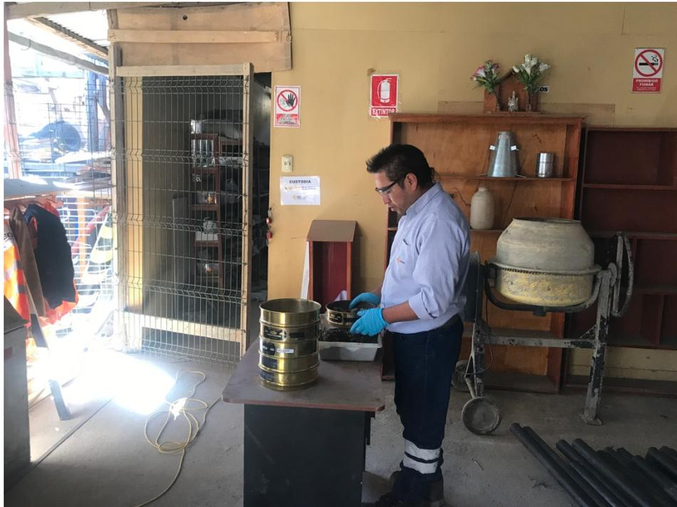
Imagen 09. Trabajos de laboratorio de suelos (Ensayo de granulométrica)
