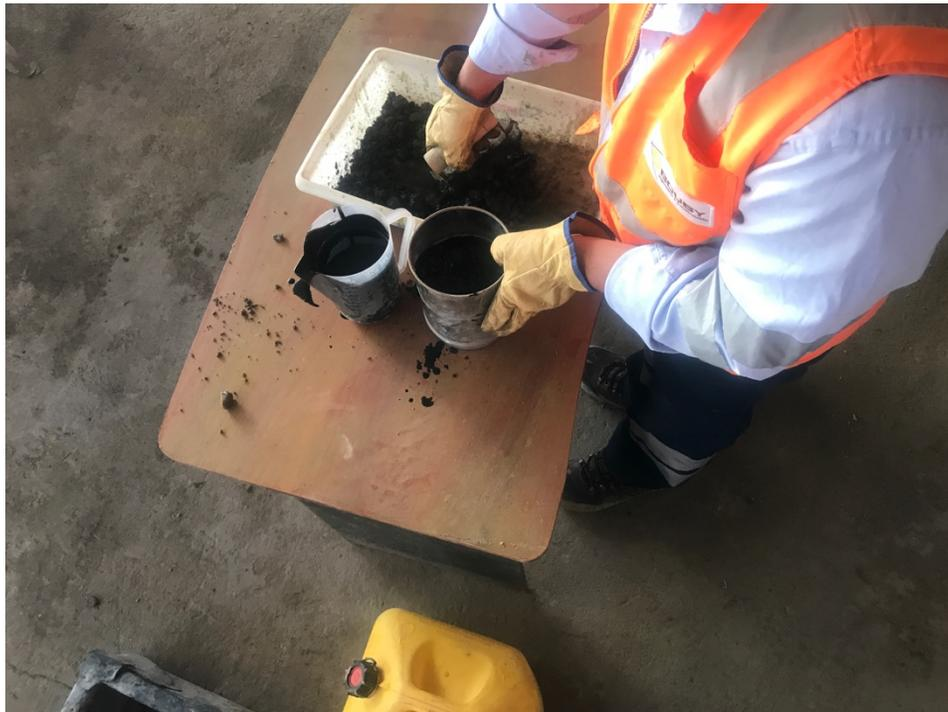
Imagen 12. Colocación de muestra asfáltica en briquetas
