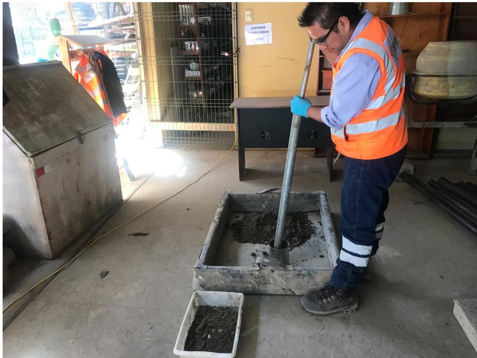
Imagen 10. Trabajos de laboratorio de suelos (Ensayos de CBR)
