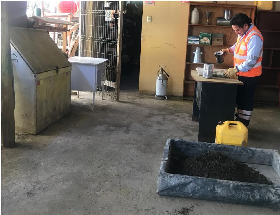
Imagen 11. Trabajos de preparación de muestra asfáltica
