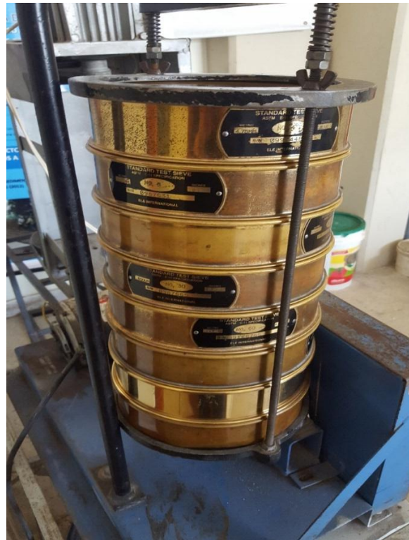
Anexo D9. Mallas granulométricas para tamizado.
