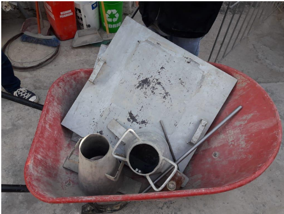
Anexo D14. Materiales para realizar la prueba de asentamiento.
