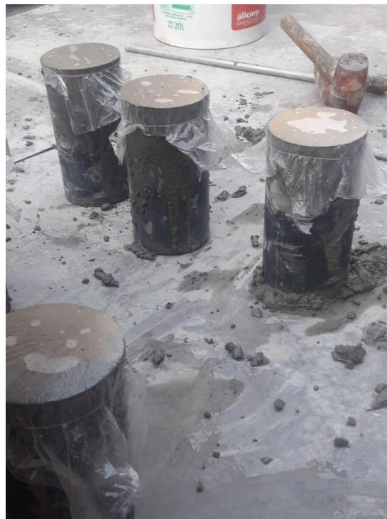
Anexo D19. Tapado de probetas con plástico para evitar el exceso de exudación.
