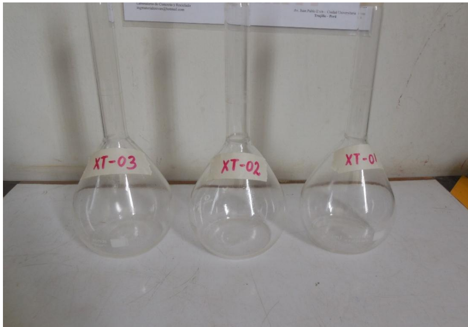
Anexo D4. Fiolas de vidrio para el ensayo de absorción y peso específico de la arena y ladrillo reciclado.
