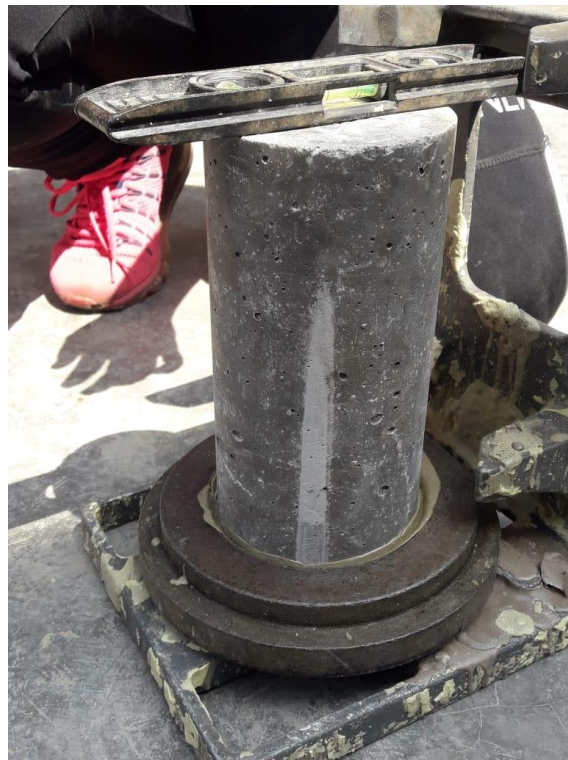
Anexo D21. Nivelando las probetas en el equipo de Caping.
