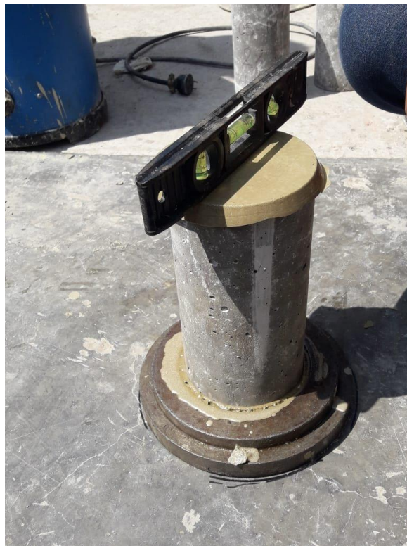
Anexo 23. Probetas capeadas y niveladas.
