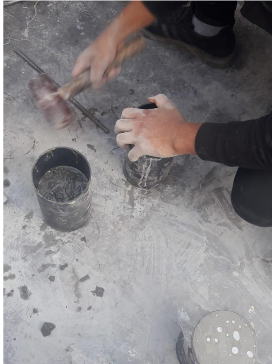
Anexo D18. Inicio del llenado de probetas de concreto.
