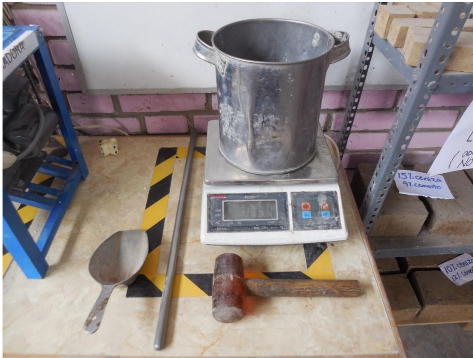
Anexo D11. Materiales para realizar ensayo de peso unitario compacto y suelto.
