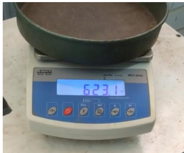
Anexo D10. Peso de mallas con material retenido.
