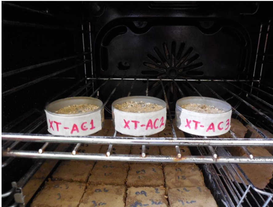
Anexo D3. Muestras para humedad en estufa de secado.
