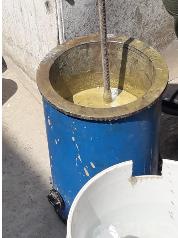
Anexo D22. Olla con azufre para realización de caping.
