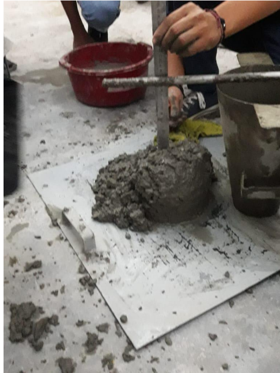
Anexo D15. Toma de medida del asentamiento.
