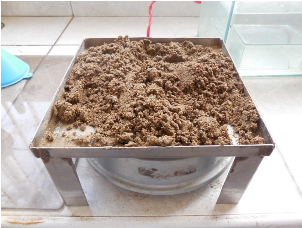
Anexo D7. Secado superficial de arena, prueba de peso específico.
