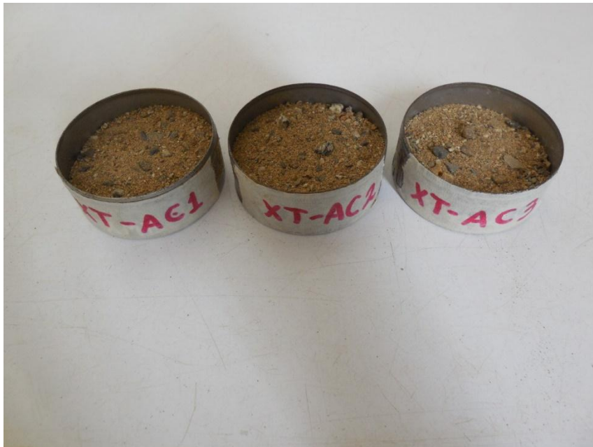
Anexo D2. Latas de secado con muestras para el ensayo de humedad.
