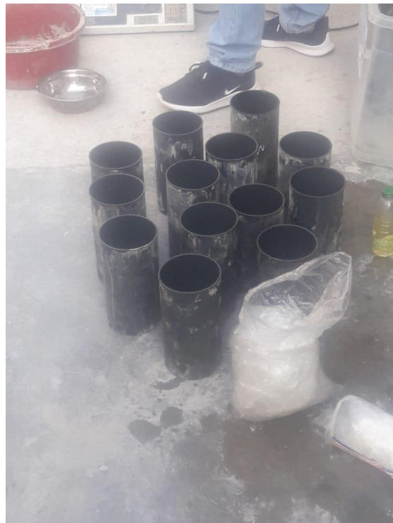
Anexo D17. Probetas para ensayo de compresión, absorción y porosidad.
