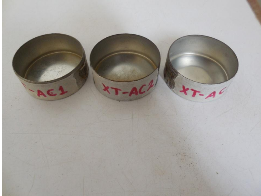
Anexo D1. Latas de secado para el ensayo de humedad.
