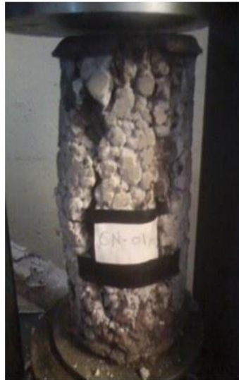
Fisura a 14 días
