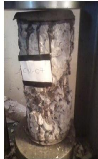
Fisura a 28 días
