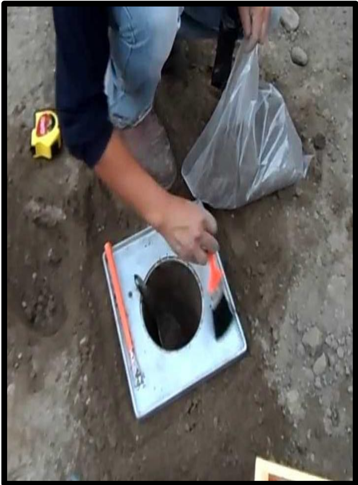
Preparando material para el ensayo Proctor modificado soda cáustica al 0%.
