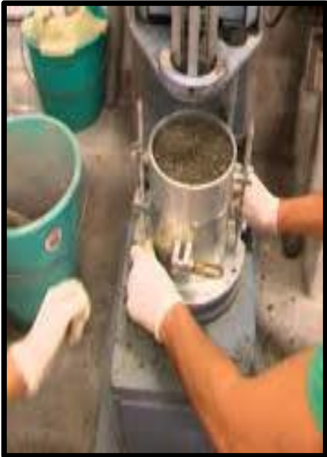
Peso de molde Proctor más muestra compactada soda caustica al 0%.
