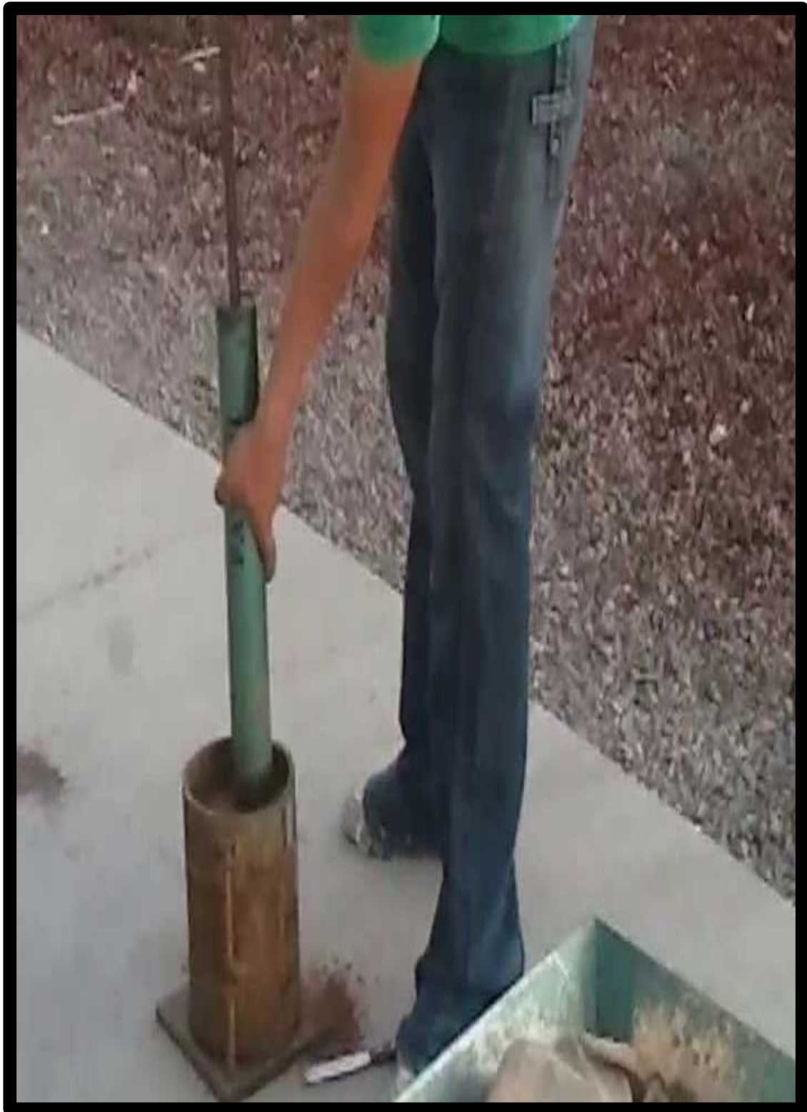
Ensayo Proctor modificado soda castica al 0%.
