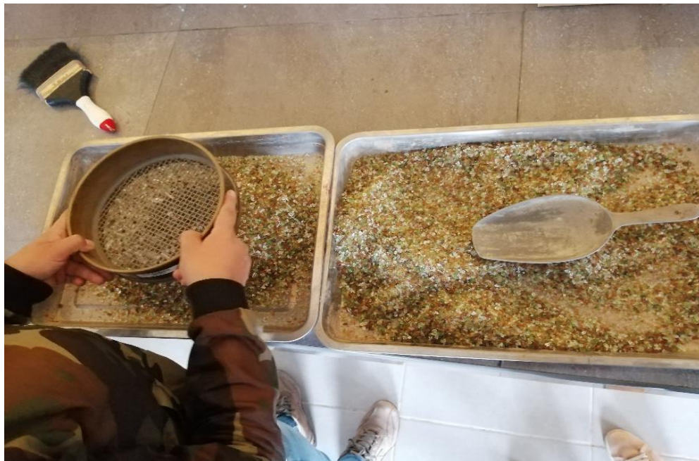
Figura 20. Tamizado de vidrio molido Fuente: Propia
