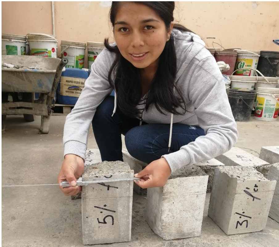
Anexo N° 51 Toma de medidas con calibre (pie de rey)
