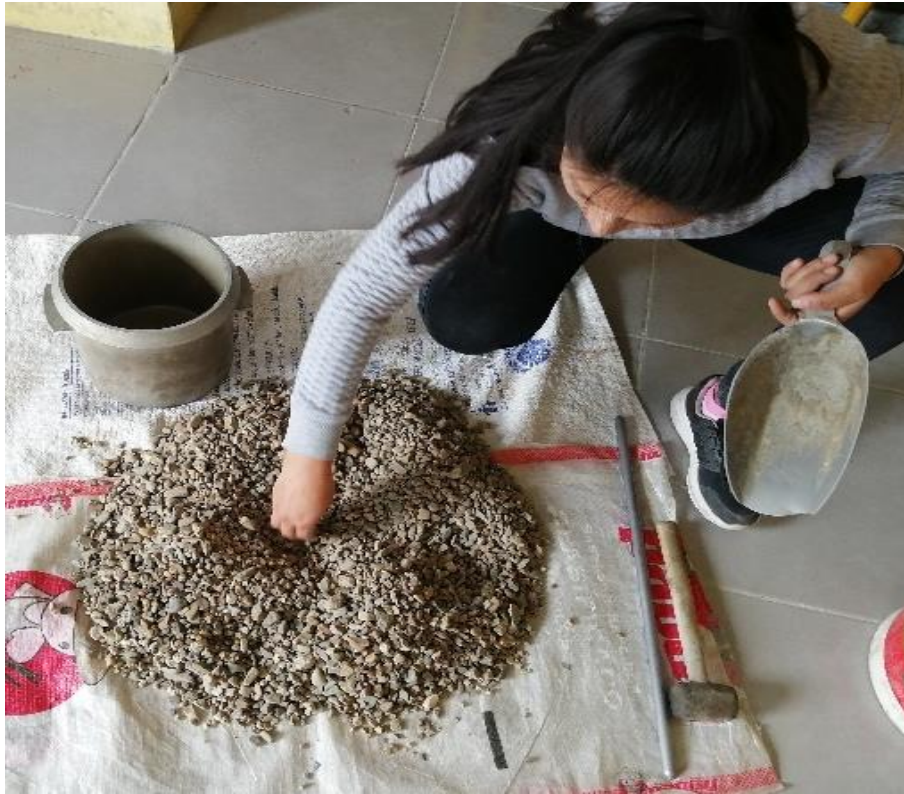
Figura 29. División de agregado grueso Fuente: Propia
