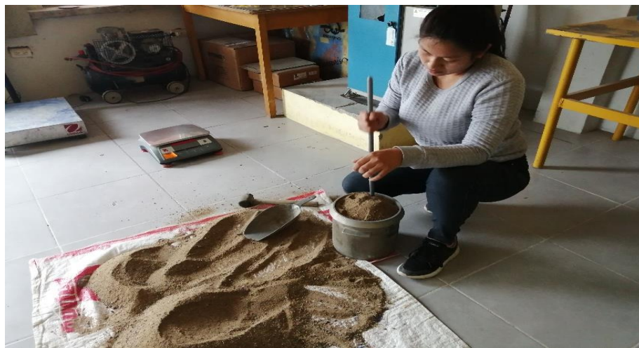
Figura 28. Proceso de varillado Fuente: Propia
