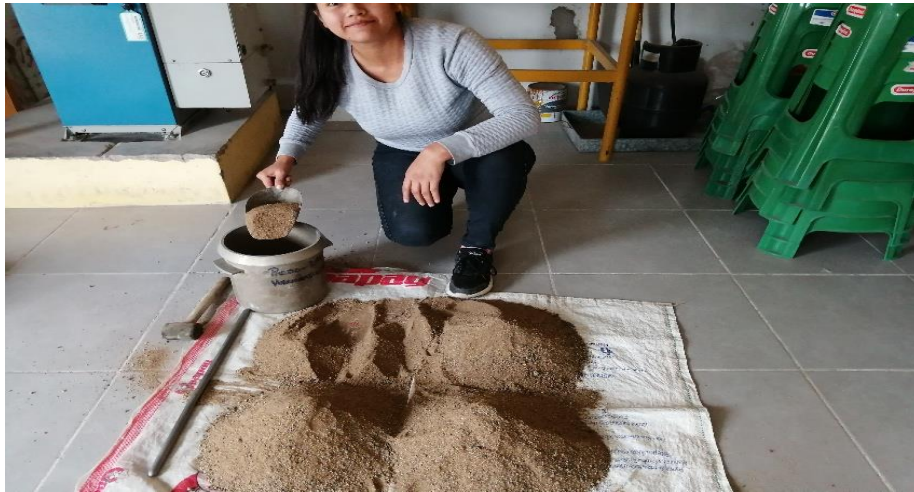
Figura 27. Llenado de agregado fino a olla Fuente: Propia
