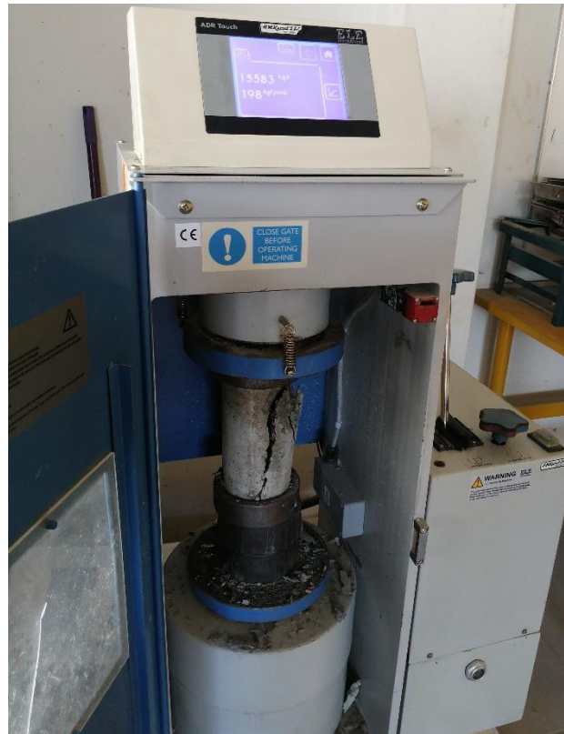
Figura 36. Ensayo a compresión
