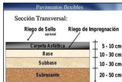
Figura 1. Sección Transversal Pavimento Flexible
