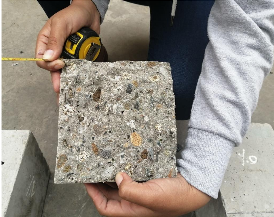
Anexo N° 50 Viga después de rotura donde se ve el vidrio molido
