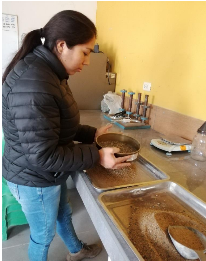
Figura 13. Tamizado de agregado fino
