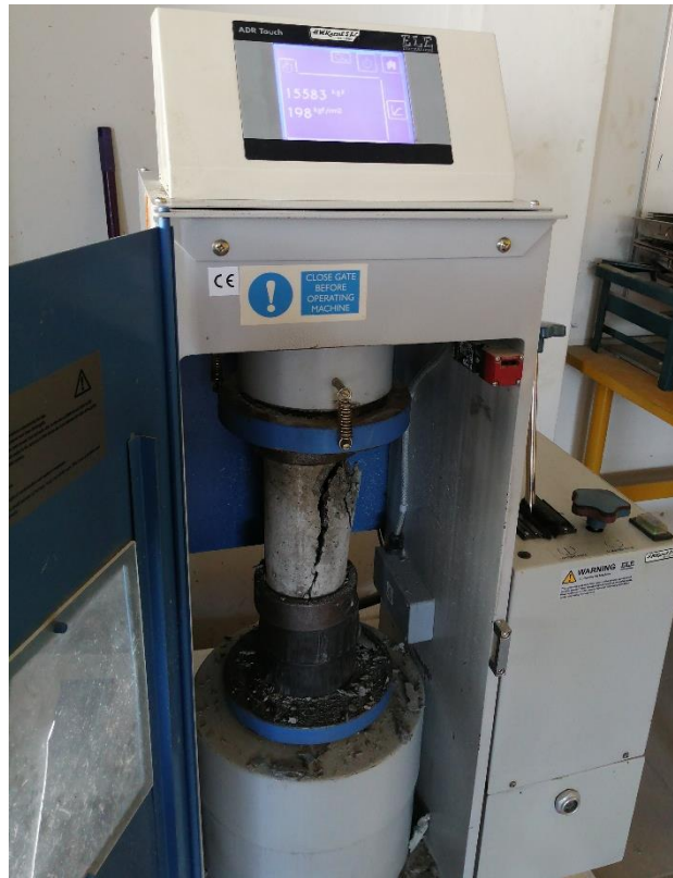
Figura 36. Ensayo a compresión
