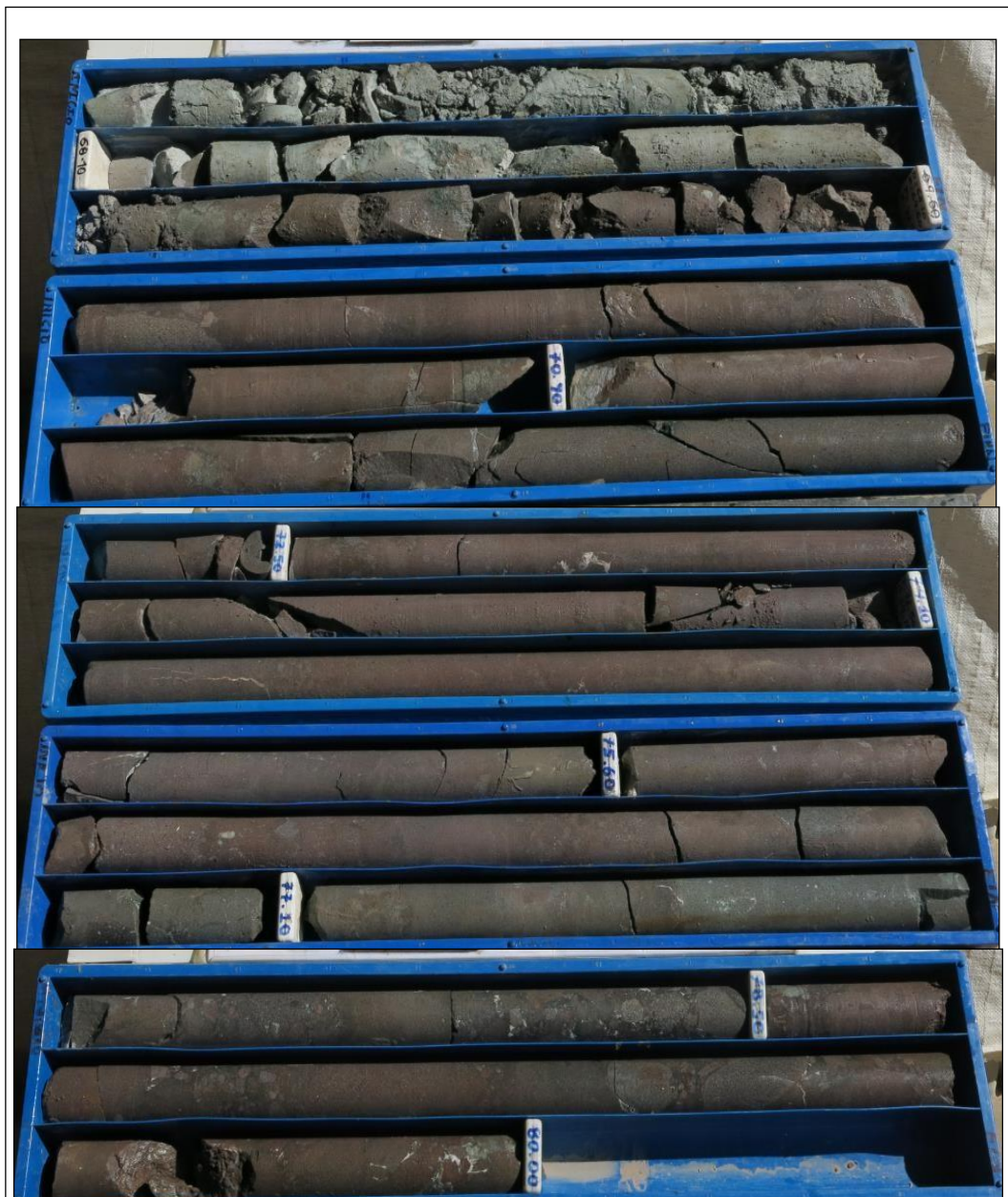
Foto N° 24: Perforación geotécnica DH-14-101, caja con muestras de 67,30 a 80,00 m.
