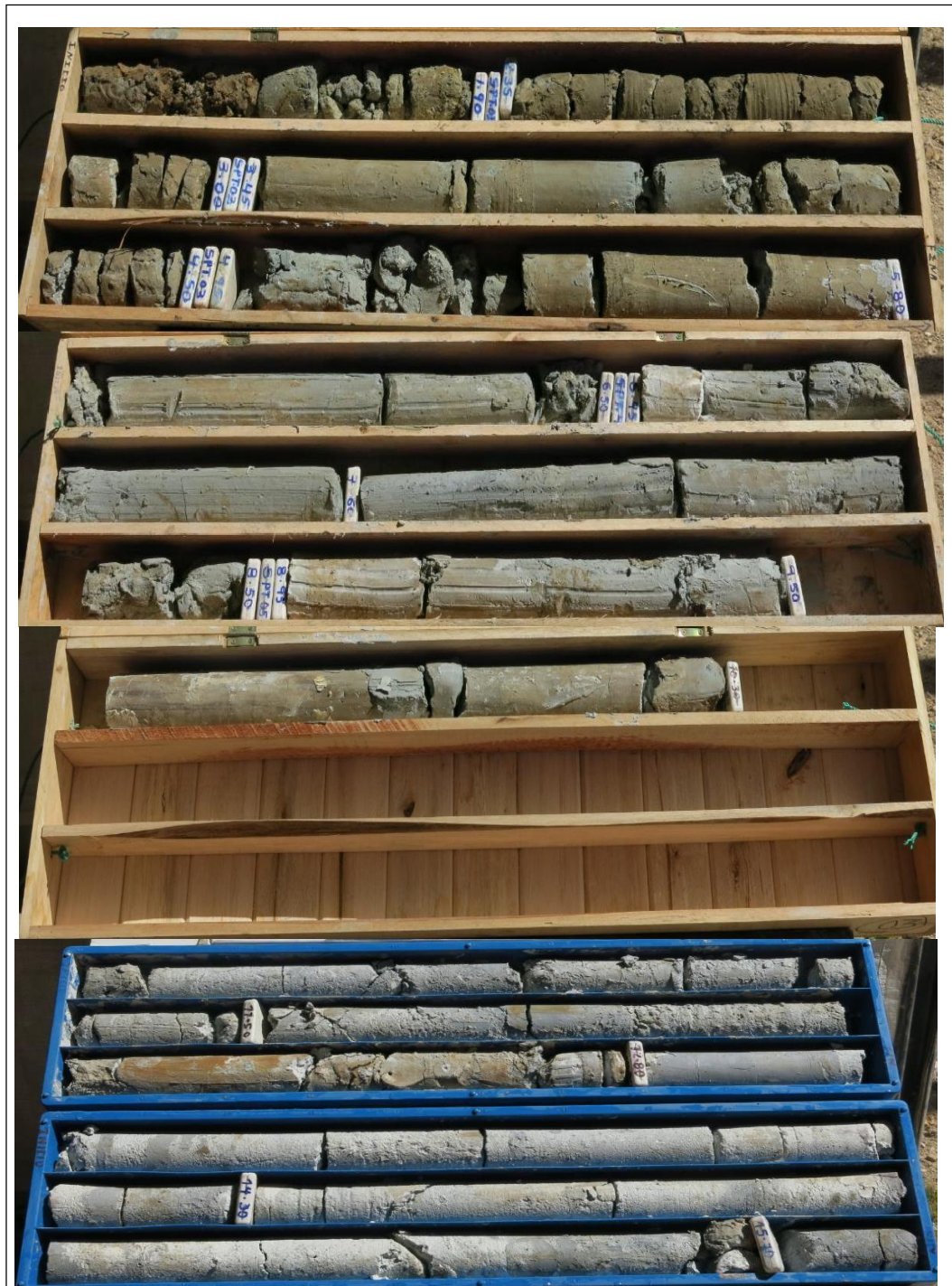
Foto N° 25: Perforación geotécnica DH-14-103, caja con muestras de 0,00 a 15,85 m.
