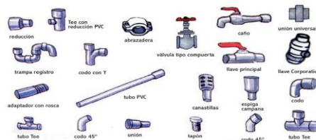
Figura 4-5 – Tuberías y accesorios
