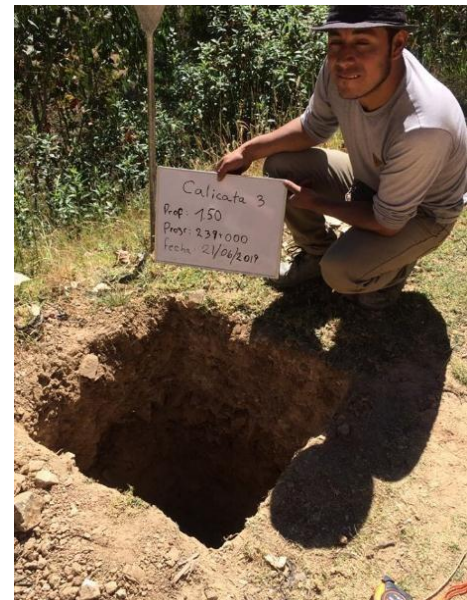
Imagen N°3 y N°4: Realización del pozo de exploración y muestreo de Material para su estudio.
