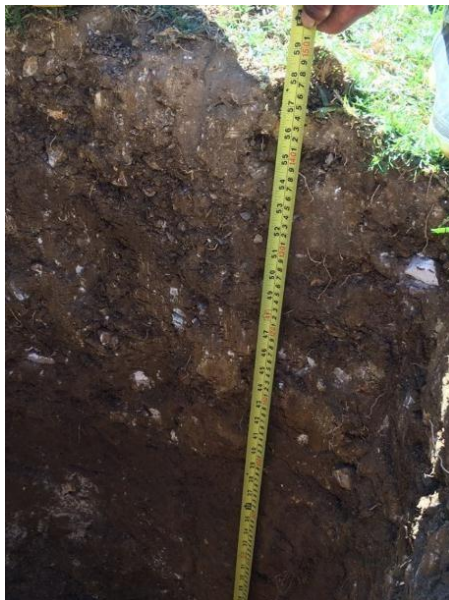
Imagen N°3 y N°4: Realización del pozo de exploración y muestreo de Material para su estudio.
