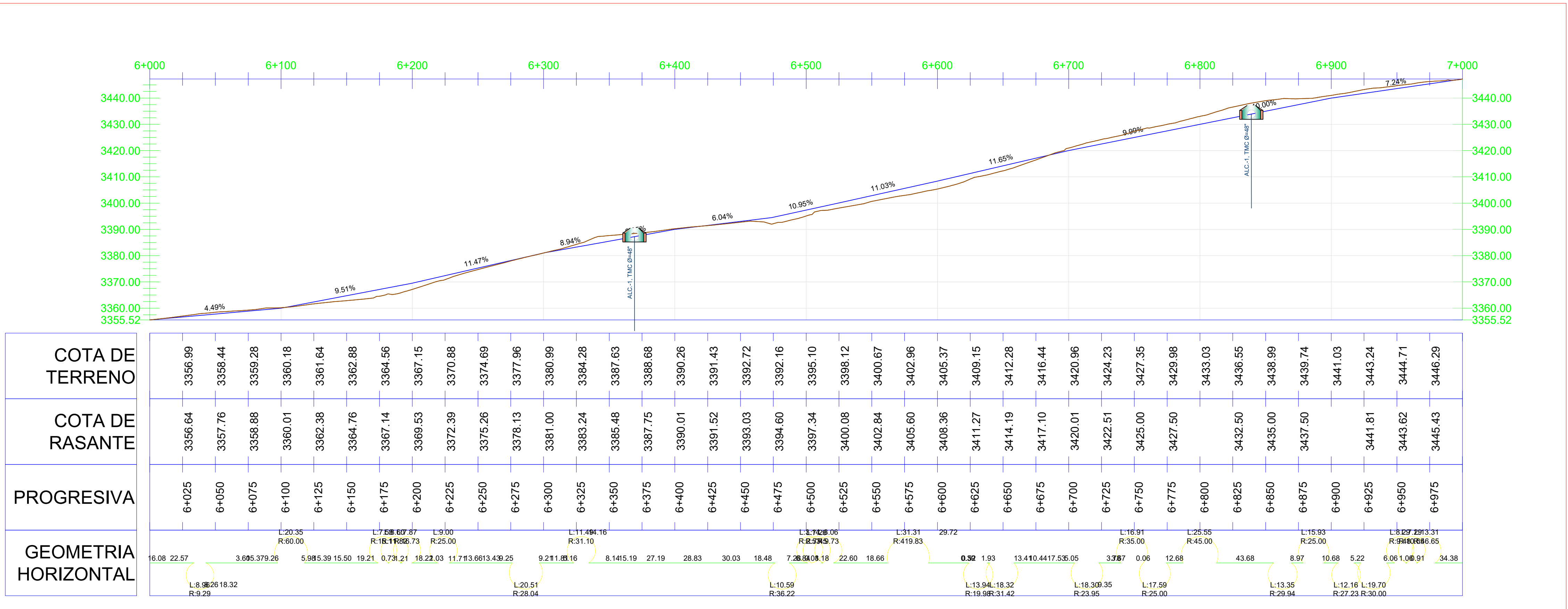
PERFIL LONGITUDINAL KM: 6+000 - 7+000 Esc. H: 1/500 V: 1/200
