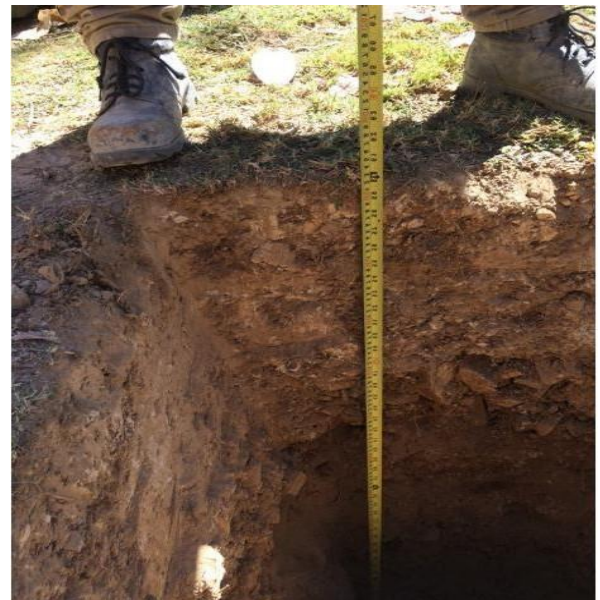
Imagen N°7 y N°8: Realización del pozo de exploración y muestreo de Material para su estudio.
