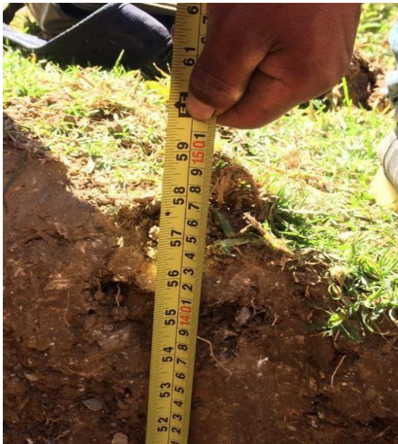
Imagen N°7 y N°8: Realización del pozo de exploración y muestreo de Material para su estudio.
