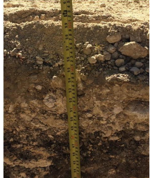
Imagen N°1 y N° 2: Realización del pozo de exploración y muestreo de Material para su estudio.
