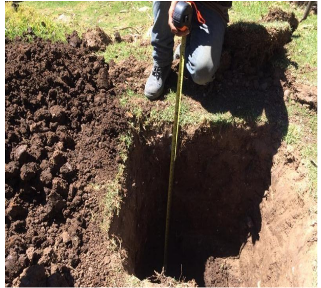
Imagen N°5 y N°6: Realización del pozo de exploración y muestreo de Material para su estudio.
