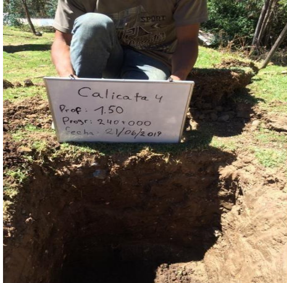
Imagen N°5 y N°6: Realización del pozo de exploración y muestreo de Material para su estudio.
