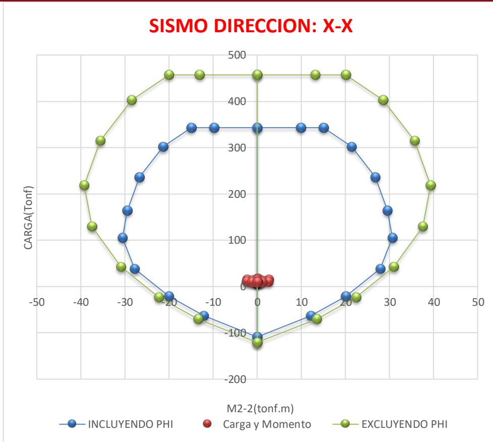
Ilustración 147: Diagrama de Interacción de Columna TEE para M2-2 del Módulo Aulas
