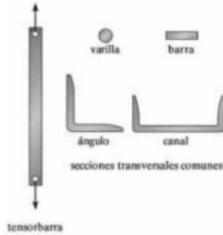
Ilustración 1: Secciones transversales comunes de Tensores.
