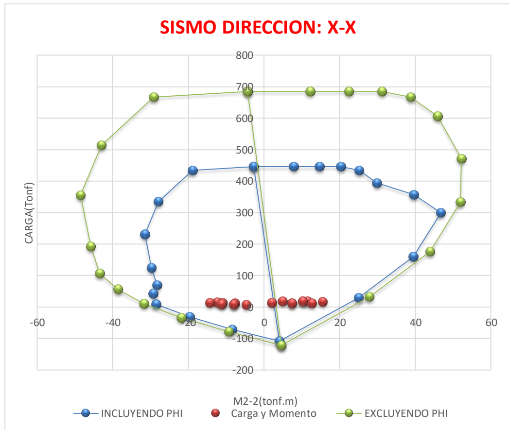
Ilustración 155: Diagrama de Interacción de Placa TEE para M2-2 del Módulo Aulas
