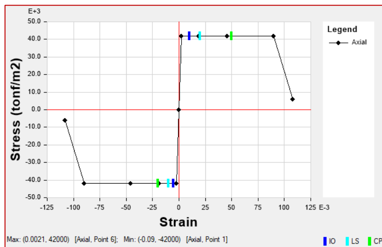
Ilustración 97: Curva Esfuerzo-Deformación del Acero f'y = 4200 \text{ kg/cm}^2
