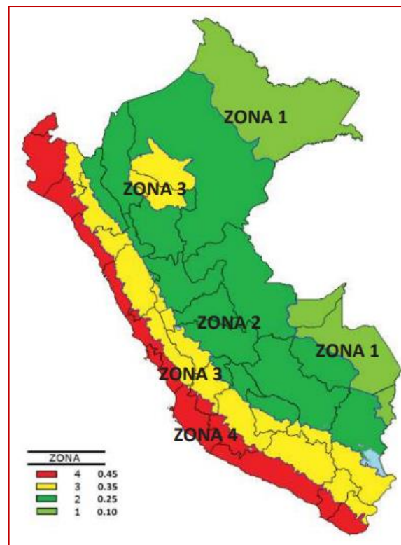
Ilustración 76: Zonificación Sísmica del Perú y sus factores de zona(Z).
