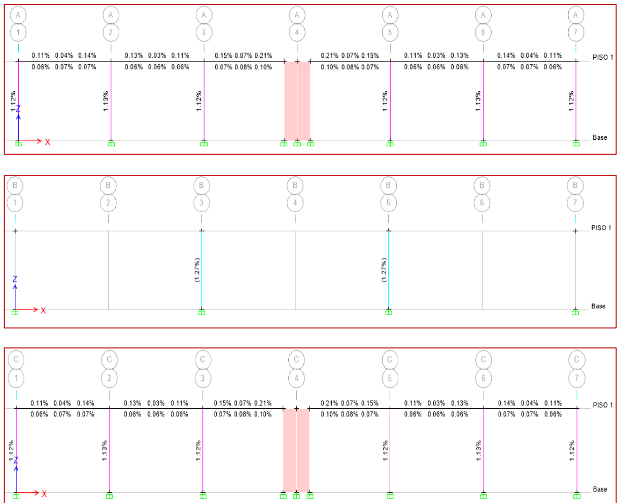
Ilustración 88: Cuantía de Columnas con el Software Etabs V.16.2.1
