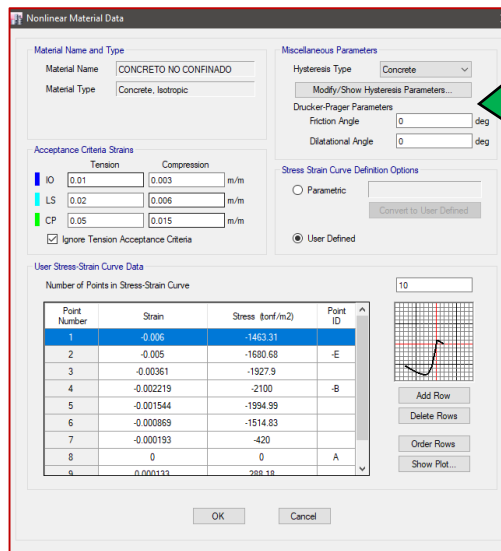
Ilustración 114: Definición del Concreto No Confinado 210 kg/cm 2 en el Software Etabs V.16.2.1
