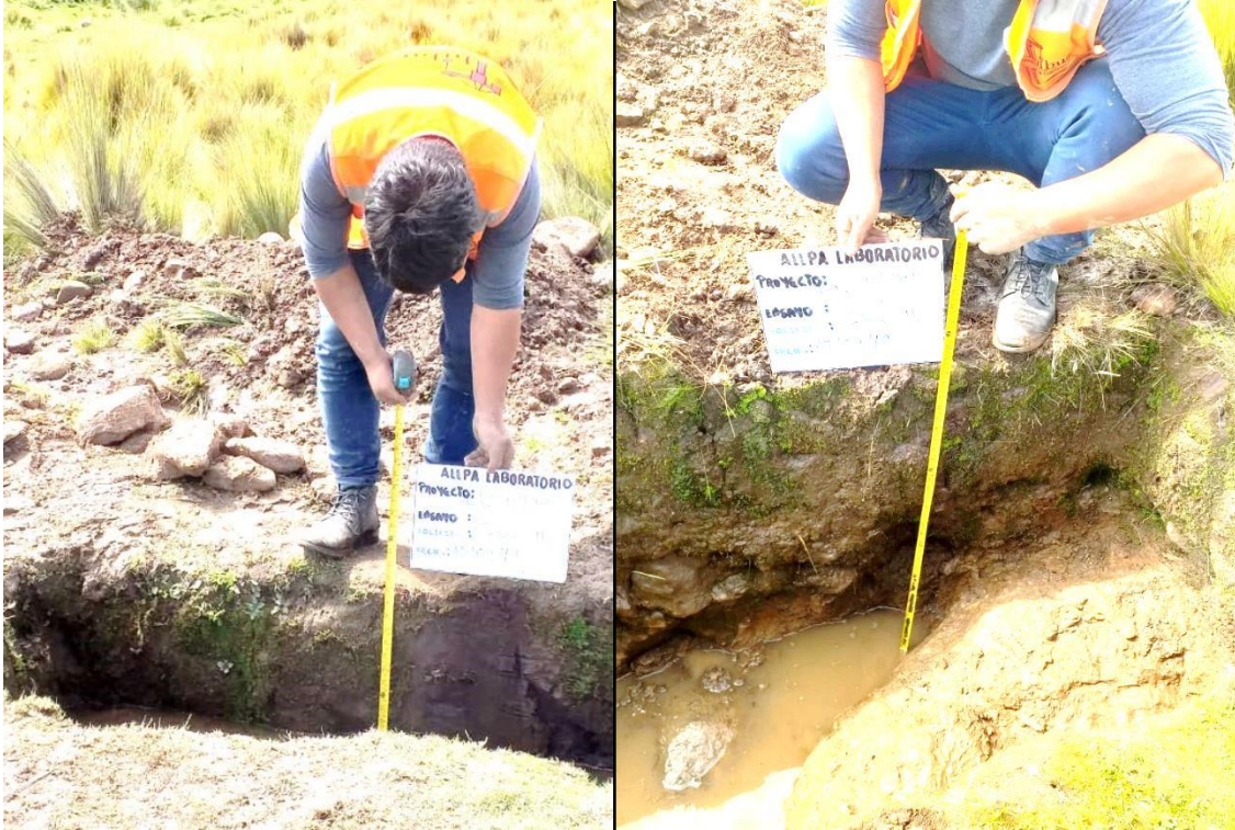
Figura. Calicatas en la comunidad de chañi.
