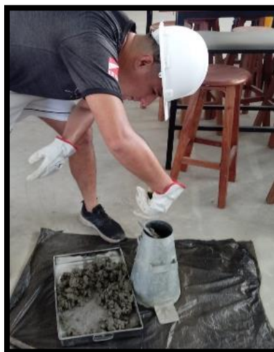
Figura 23 – Se lleva el concreto en 3 capas
