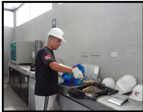
Figura 9 - Pesado de tara y muestras + tara Fuente: Elaboración Tesistas
