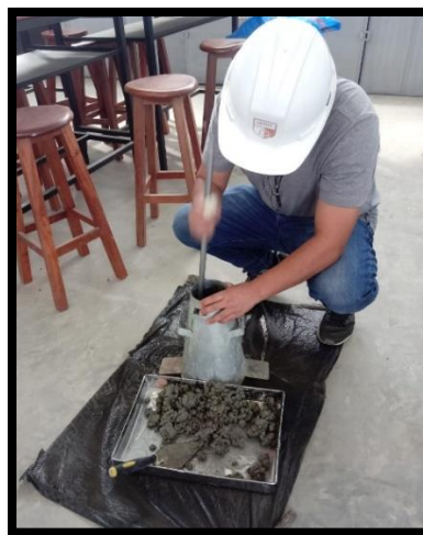
Figura 36 – Se procede a evaluar la consistencia del concreto slump
