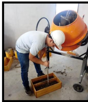
Figura 40 – Llenado y compactado de las vigas en 3 niveles con 25 golpes cada uno.
