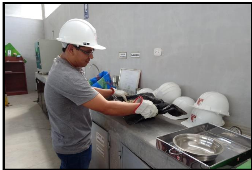
Figura 18 – Pesado de materiales para el concreto poroso
