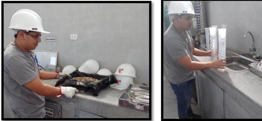
Figura 34 – Pesado de los agregados, agua y cemento para el concreto de 15%, 17%, 19% y 23% de vacíos.
