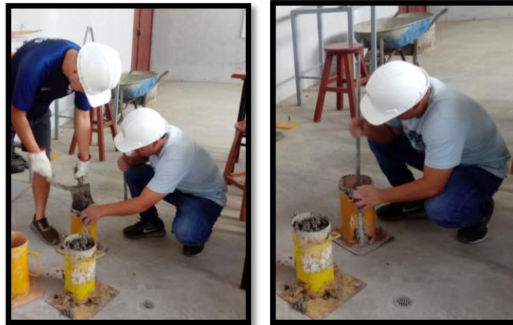
Figura 39 – Llenado y compactado de concreto en 3 niveles con 25 golpes cada uno.
