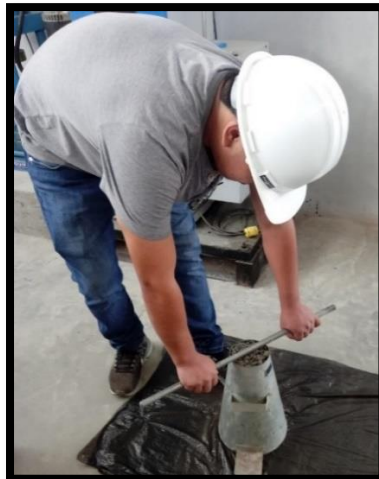
Figura 25 – Se nivela la parte superior Fuente: Elaboración Tesistas
