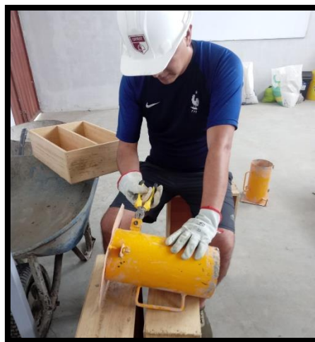
Figura 17 – Cilindros Metálicos (Moldes Probetas) Fuente: Elaboración Tesistas
