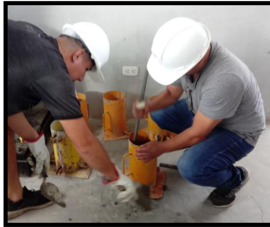
Figura 29 – Se da 25 golpes uniformes por capa Fuente: Elaboración Tesistas
