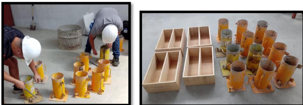
Figura 38 – Se pesa y mide el recipiente metálico para saber el peso y volumen
