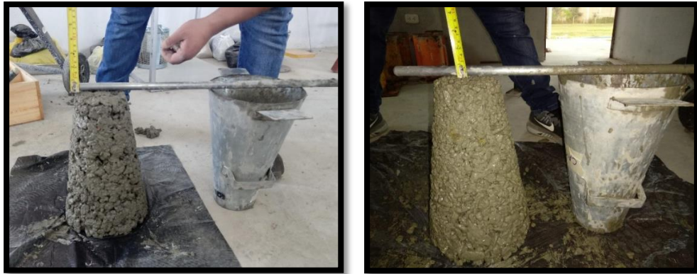
Figura 37 – Se mide el asentamiento de los concretos con 15%, 17%, 19% y 23% de vacíos.
