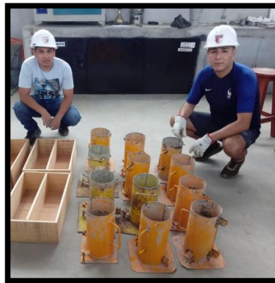
Figura 27 – Se pesa y se calcula el volumen del molde metálico
