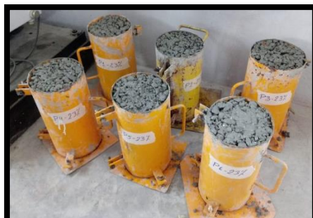
Figura 41 – Se pesa las probetas y vigas llenas con concreto para anotar el peso.
