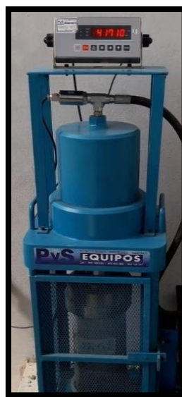
Figura 33 – Carga máxima soportada por las probetas patrón 15%.
