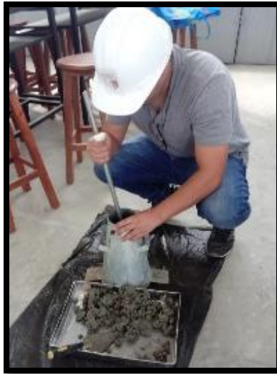
Figura 24 – Cada capa se da 25 golpes con la barra Fuente: Elaboración Tesistas
