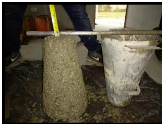
Figura 26 – Se levanta el cono y se mide el asentamiento Fuente: Elaboración Tesistas
