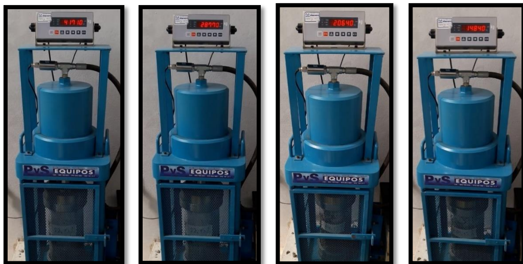
Figura 44 – Carga máxima soportada por las probetas 15%, 17%, 19% y 23%.
