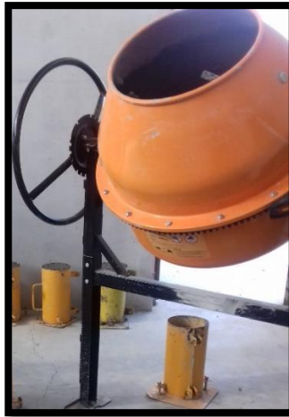
Figura 15 – Mezclador de concreto, Cilindro de metal Fuente: Elaboración Tesistas
