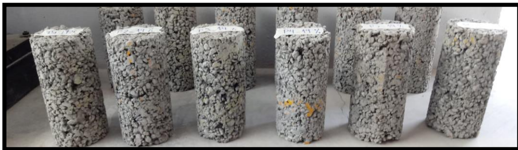
Figura 31 – Muestras en la poza de curado a 28 días
