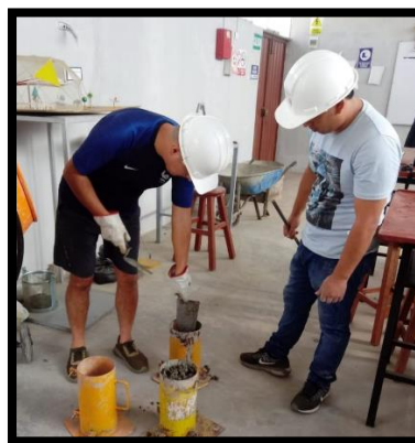
Figura 28 – Se llena el concreto en el molde en 3 capas
