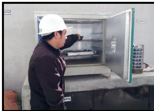
Figura 10 - Se coloca las muestras en el horno 24h Fuente: Elaboración Tesistas
