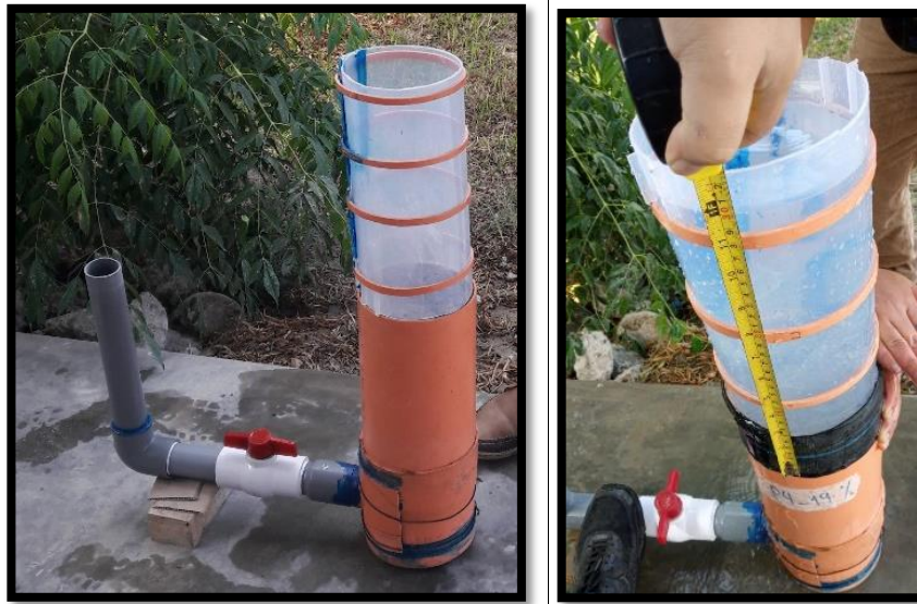
Figura 47 – Construcción del permeámetro para el ensayo de permeabilidad.
