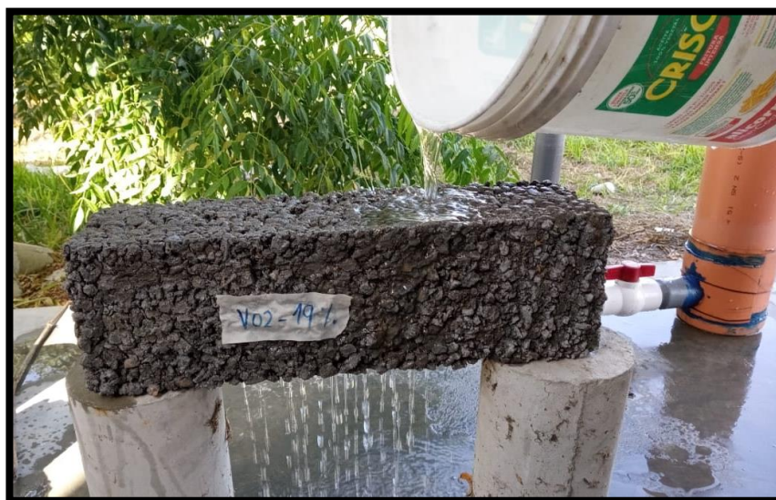
Figura 50 – Prueba de permeabilidad de la viga
