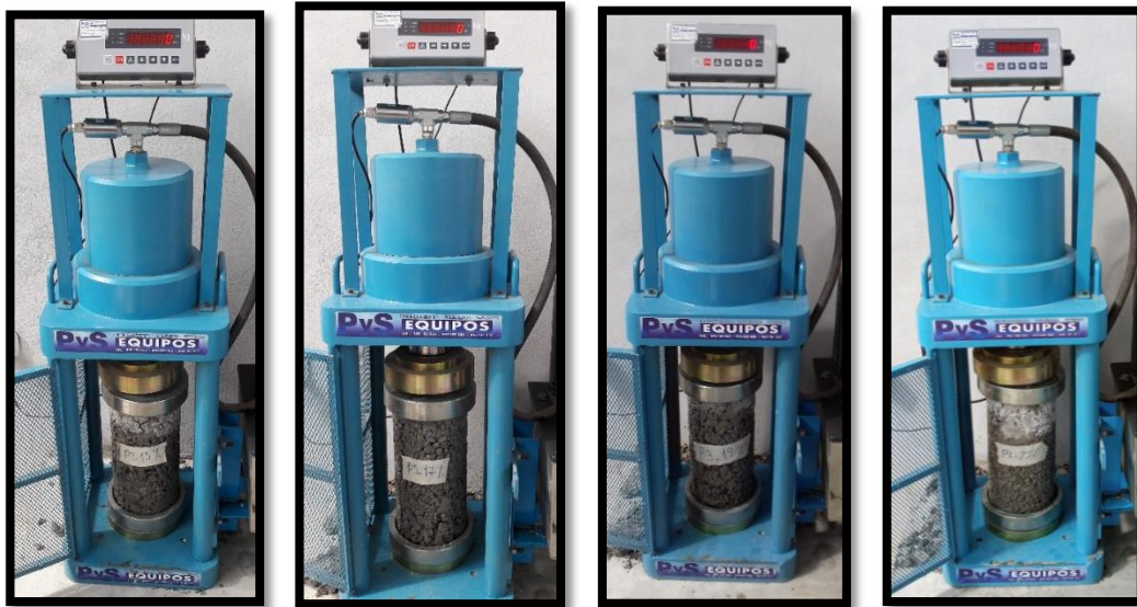
Figura 43 – Probetas etiquetadas de 15%, 17%, 19% y 23% antes de la prueba
