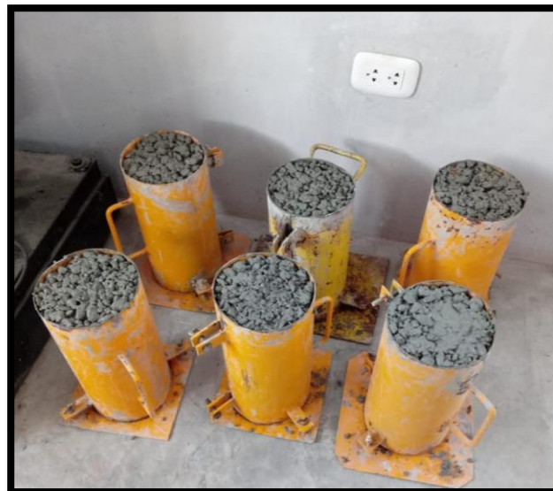
Figura 30 – Se nivela y pesa el molde lleno de concreto Fuente: Elaboración Tesistas
