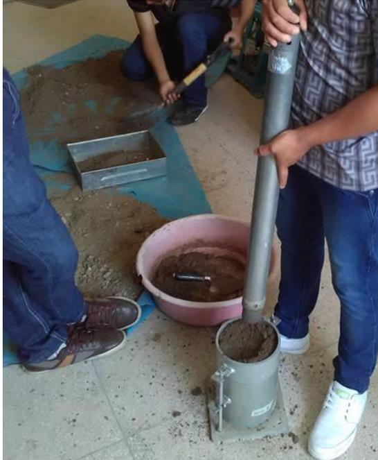
**Figura B1:** Aplicación de proctor
