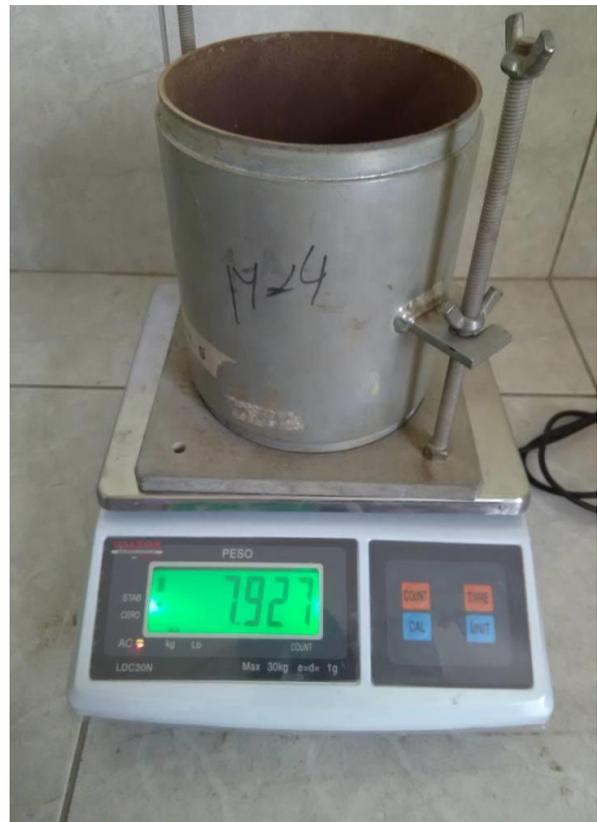
**Figura B8:** Peso de equipo de proctor.
