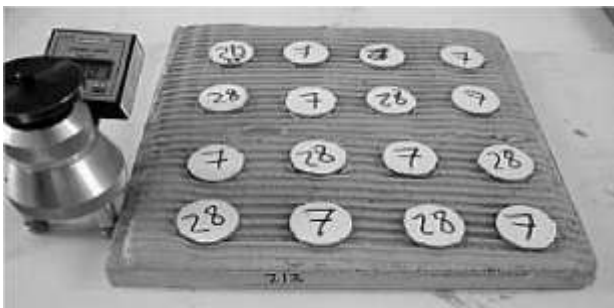
Figura 5. Ensayos de adherencia de morteros para revocos y morteros cola de los morteros de cola, esto se refleja en la norma UNE-EN 1348.
