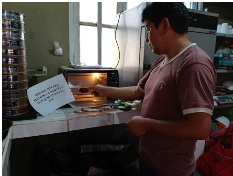
Foto N° 04: Usando el horno para secar la muestra en el laboratorio.
