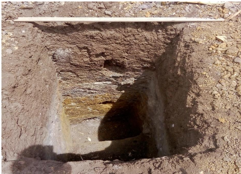
Calicata N° 03: Excavación y extracción de muestras de suelo para ser analizadas en laboratorio.
