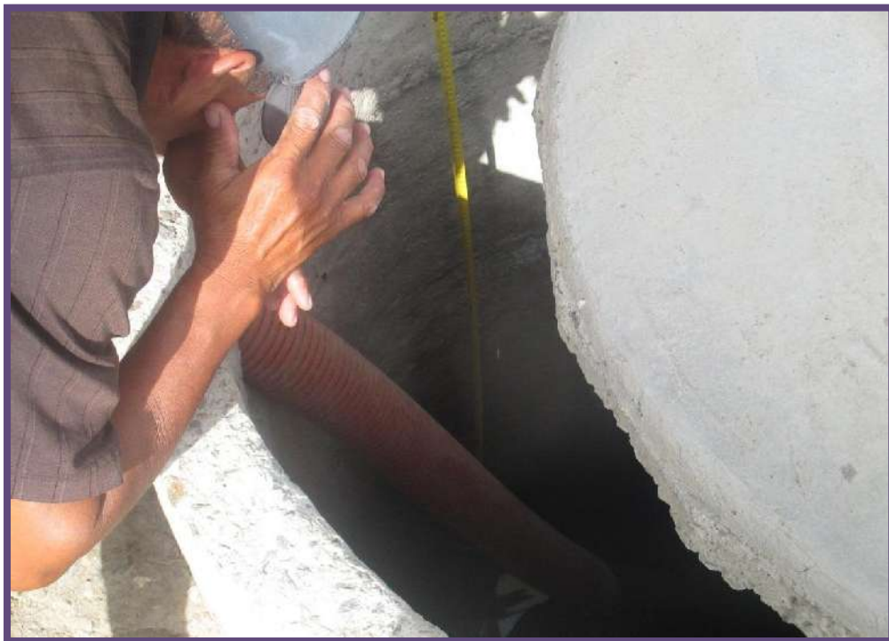
FOTO 22.A: MIDIENDO LA ALTURA DEL NIVEL DINÁMICO DEL AGUA
