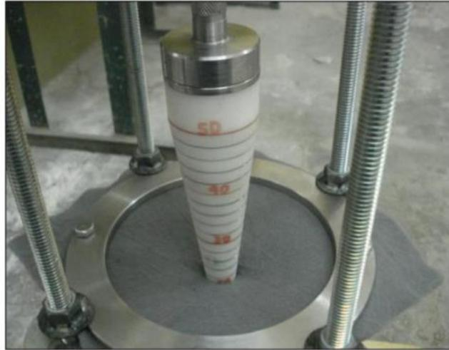
Figura 45. Cono de medida dentro del orificio.
