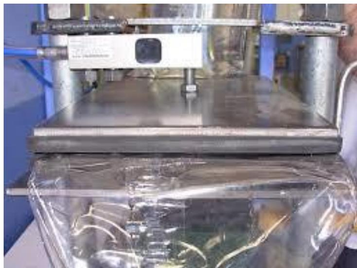
*Figura 52.* Imágenes del dispositivo adoptado para la determinación de las características de permeabilidad planar.
