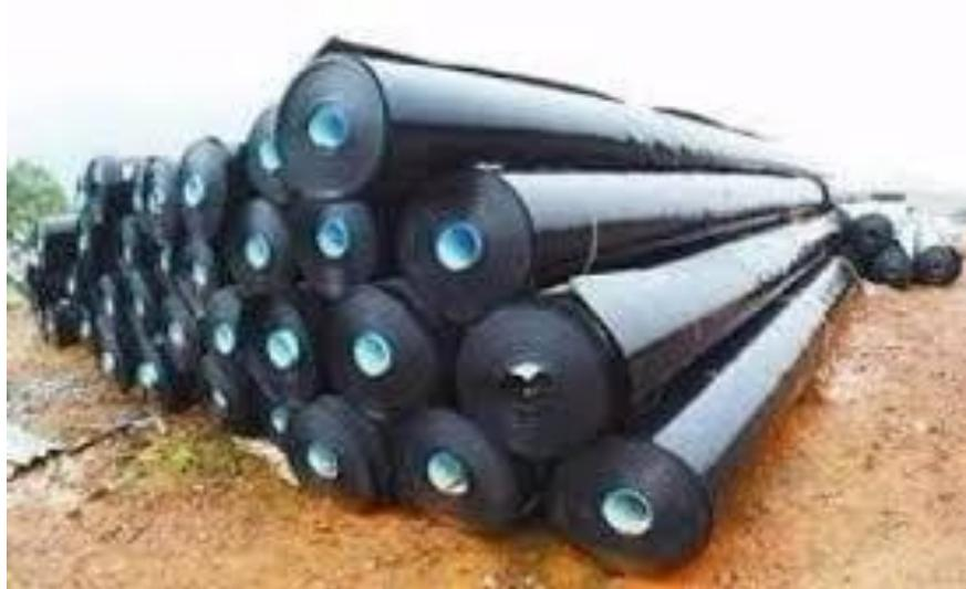
*Figura 65. Almacenamiento de la geomembrana*
