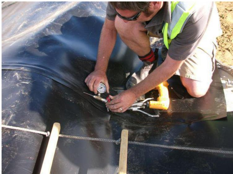
Figura 84. Realizando la prueba de presurización
