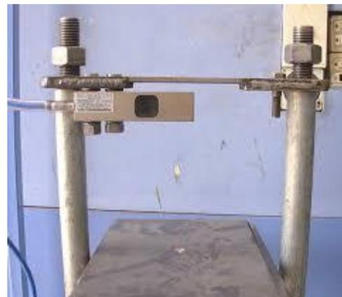
Pórtico y celda de carga para aplicar esfuerzos de compresión sobre la probeta y lograr lecturas precisas.
