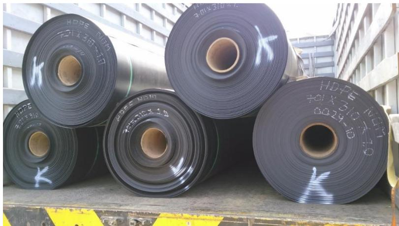
Figura 69. Almacenamiento de los rollos de geomembranas
