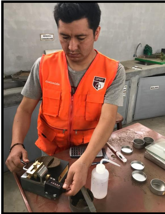
Figura 16. Límites de Atterberg laboratorio de la UPRIT.
