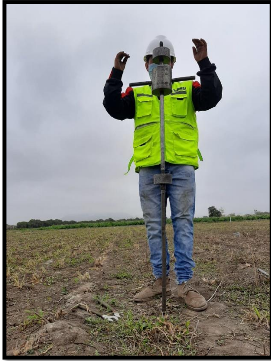
Figura 18. Ensayo Penetrómetro Dinámico Ligeró DPL.
