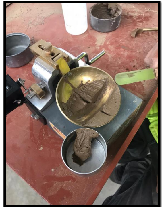
Figura 16. Límites de Atterberg laboratorio de la UPRIT.
