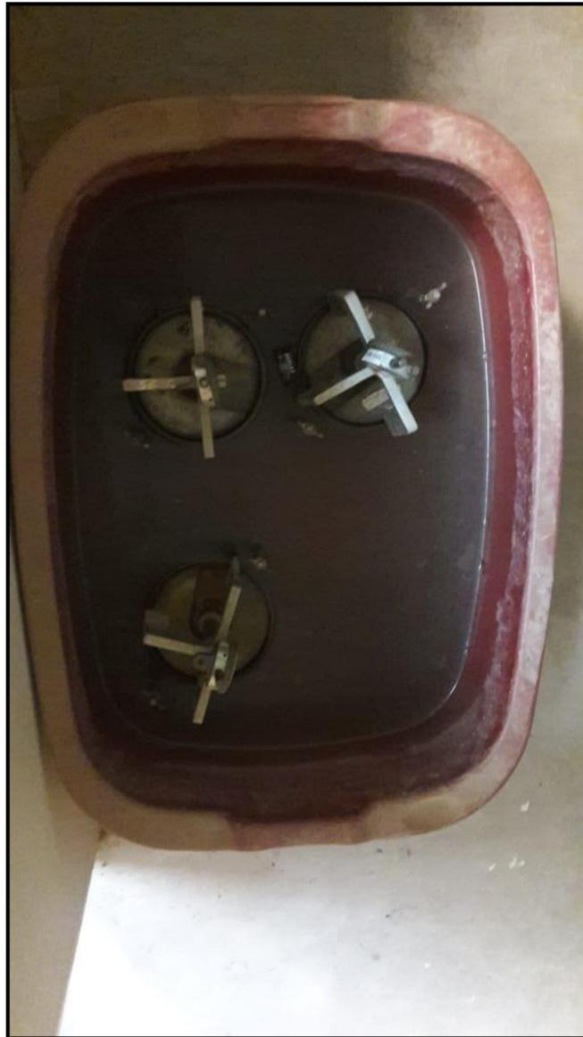
Muestras sumergidas de ensayo CBR *Laboratorio de Suelos*
