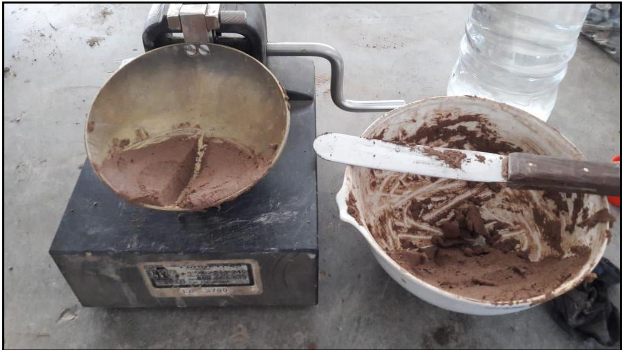
Ensayo de Límites de consistencia de muestras C-01 y C-02
