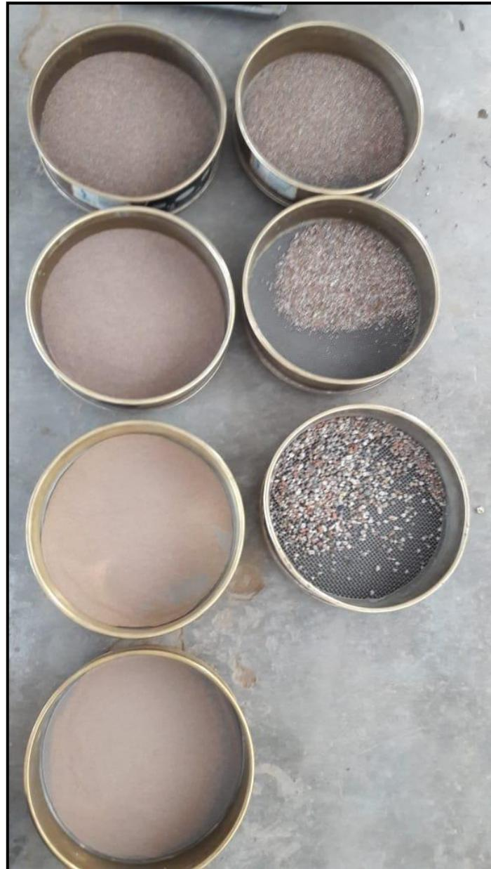
Tamizado de muestra de Calicata N° 01 – Análisis Granulométrico
