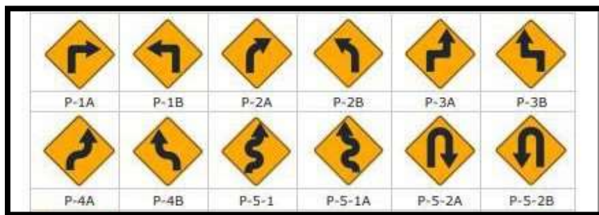
Figura 18: señales preventivas – curvatura horizontal
