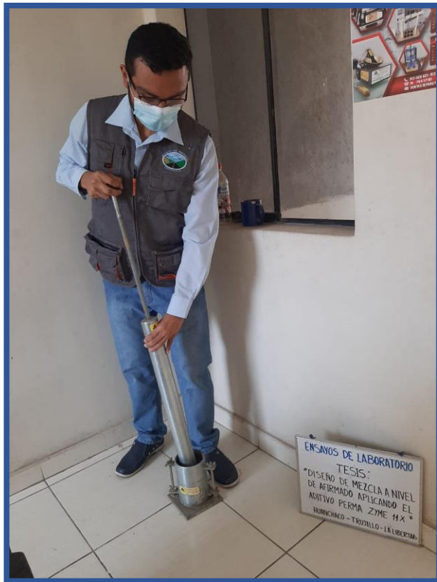
Figura 8: Ensayos de Laboratorio - Proctor Modificado
