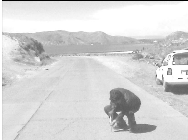
Figura N°18.3. Ensayo con el equipo de esclerómetro
