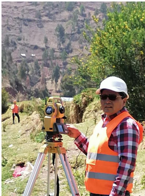
Foto 2: Levantamiento topográfico en el área de influencia del río.
