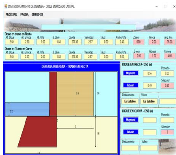
Figura 13 : Dimensionamiento de defensa – dique enrocado lateral
