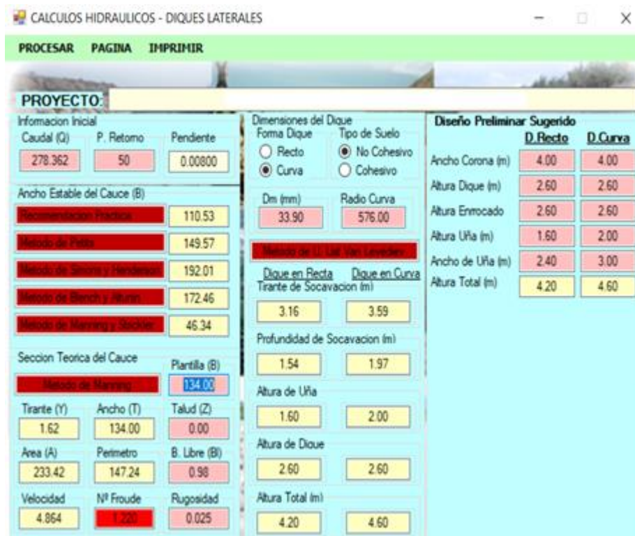
Figura 12 : Calculos hidráulicos – diques laterales
