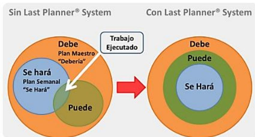
*Figura 5: Lean Construction y la planificación colaborativa. Metodología del Last Planner® System (LPS).*
