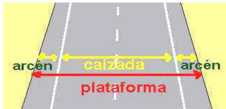
*Figura 6: Diseño de una calzada y arcen*
