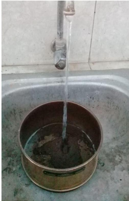
FOTO 17. Separación de arenas de finos mediante el lavado por malla N°200 (75um).
