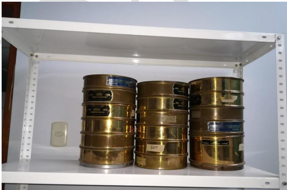
FOTO 16. Mallas granulométricas para tamizado de suelos.
