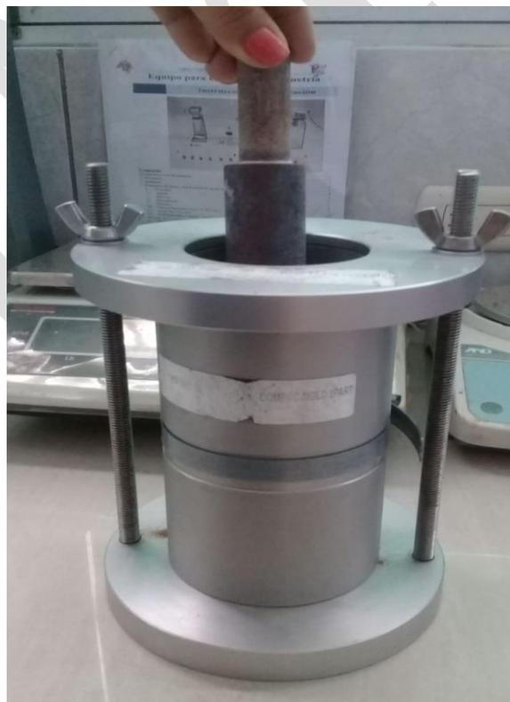
FOTO 20. Conformado de la probeta para densidad relativa.
