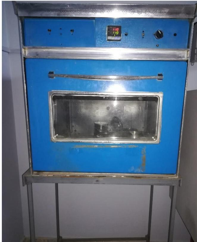
FOTO 15. Secado de muestra a 110 °C. Ensayo de humedad.
