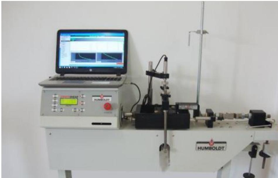
FOTO 21. Ensayo de resistencia al corte.
