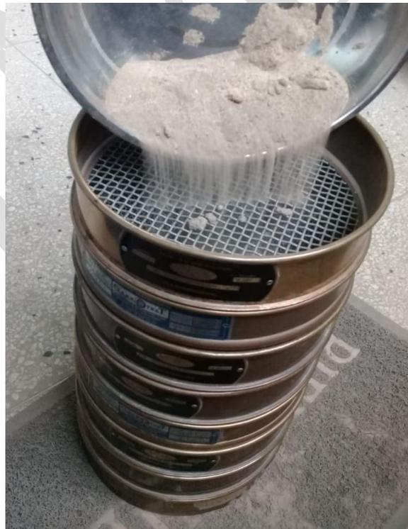
FOTO 18. Granulometría por tamizado de las arenas secas después de la separación de los finos.
