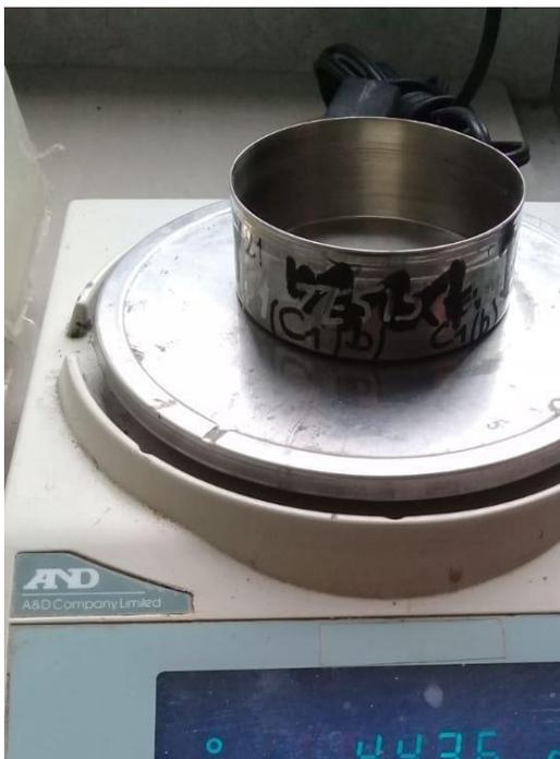
FOTO 13. Pesado de lata de secado para el ensayo de humedad.
