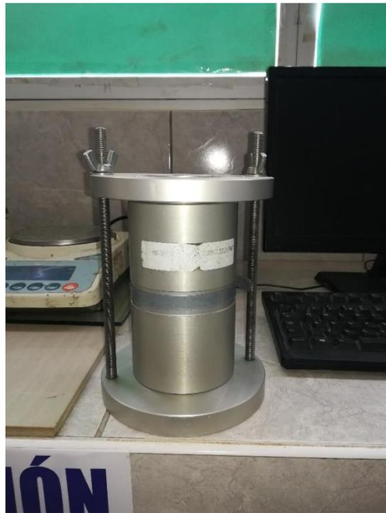
FOTO 19. Molde de hacer inoxidable para elaboración de probetas para el ensayo de densidad relativa.
