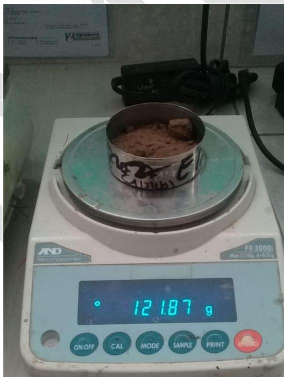
FOTO 14. Pesado de muestra para el ensayo de humedad.
