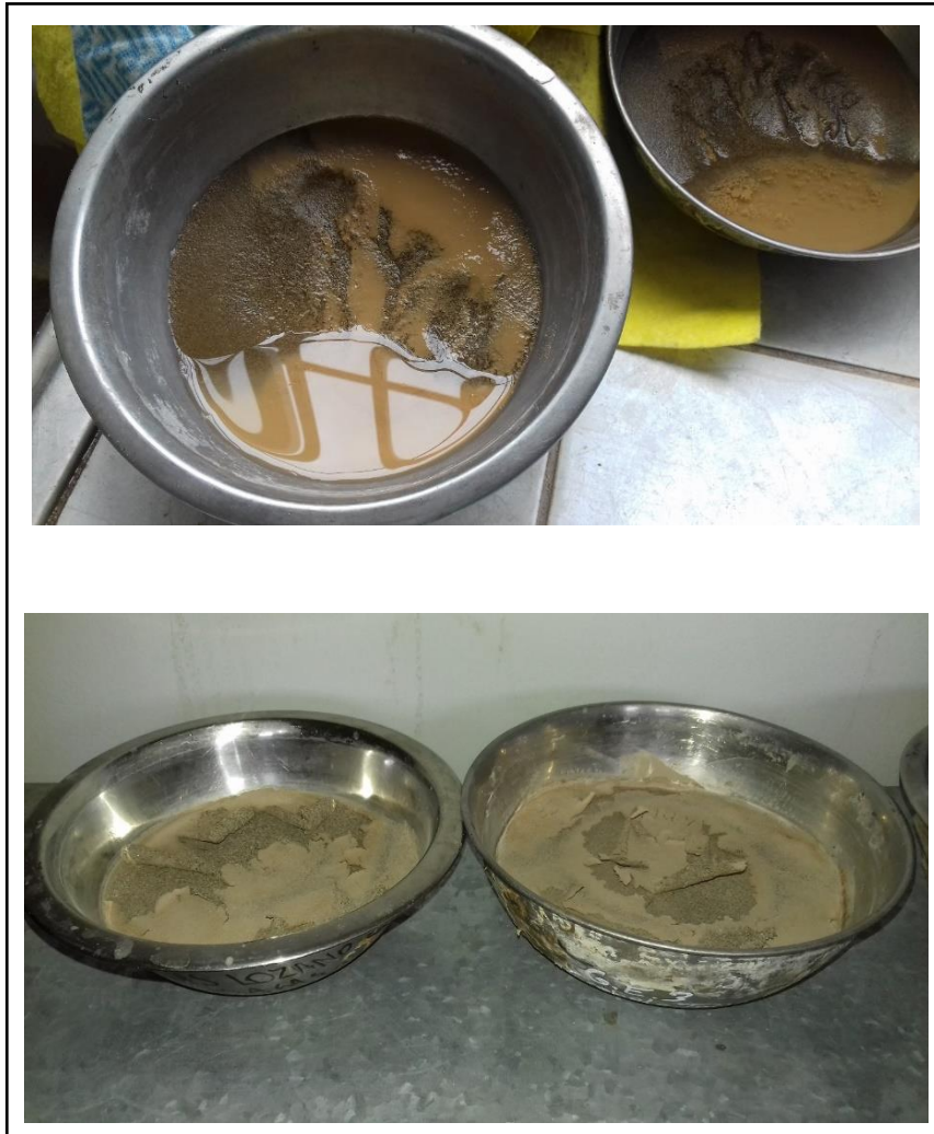
Figura 27. Ensayo de peso específico y absorción de la arena fina.
