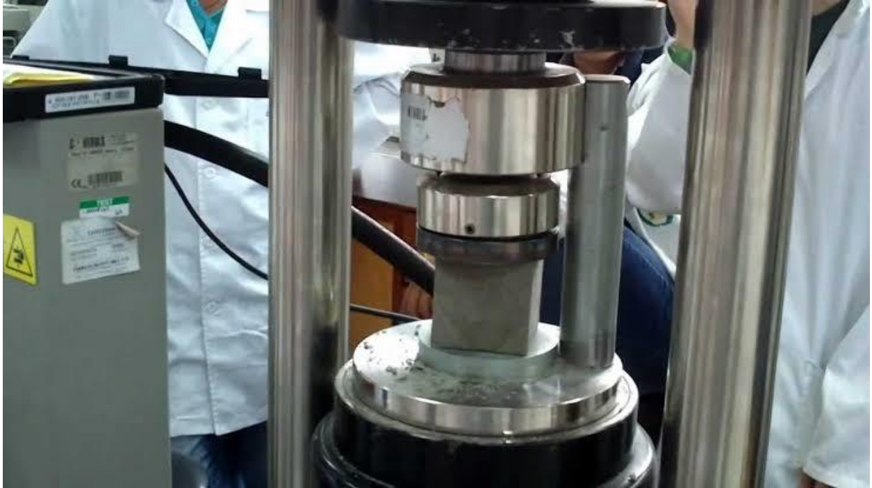
Figura 29. Ensayo de resistencia a la compresión del mortero.
