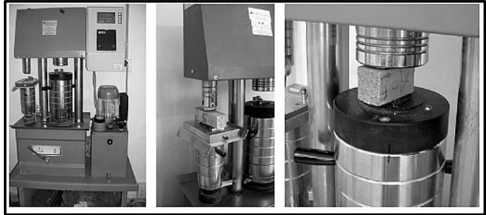
Figura 2. Izquierda: Prensa para ensayos mecánicos. Centro: Ensayo de flexión. Derecha: Ensayo de compresión.
