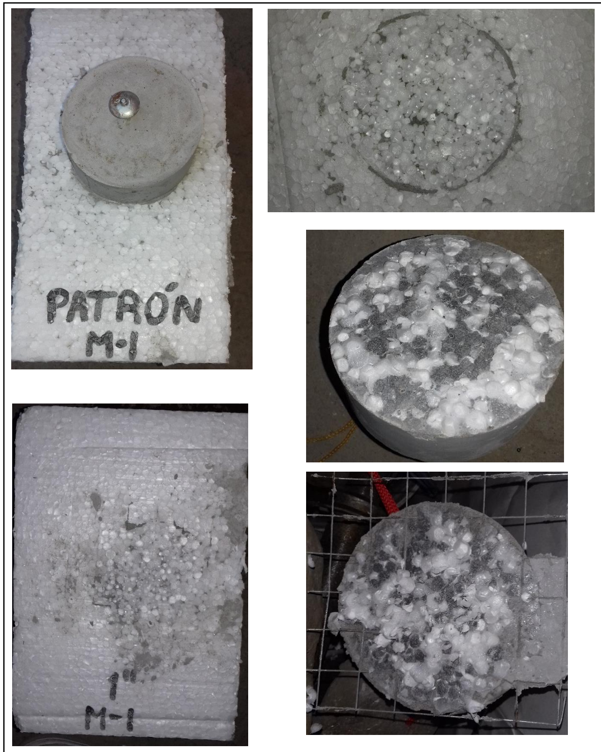
Figura 32. Muestras antes y después de ensayo de resistencia a la tracción del mortero.
