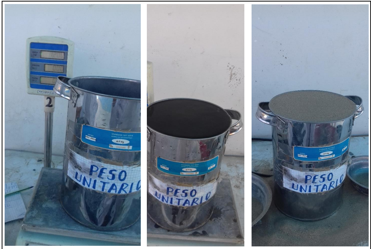
Figura 28. Ensayo de peso unitario de la arena fina.
