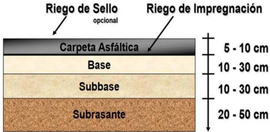
Gráfico 1: Capas del Pavimento Flexible Asfáltico
