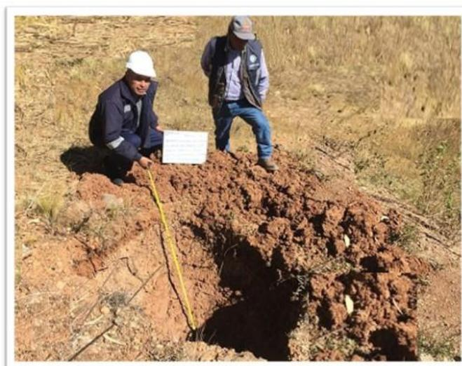
observar directamente el terreno, y recoger muestras cambiadas y no perturbadas en la bolsa (Mab), y clasificar manual y visualmente cada muestra obtenida por el muestreador, y registrar en el estrato Diferentes Se pueden observar características del estrato subyacente, como tipo
