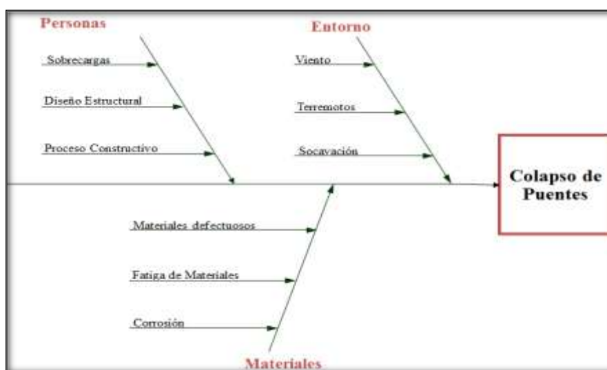
FIGURA N°14 Diagrama causa-efecto en colapso de puentes
