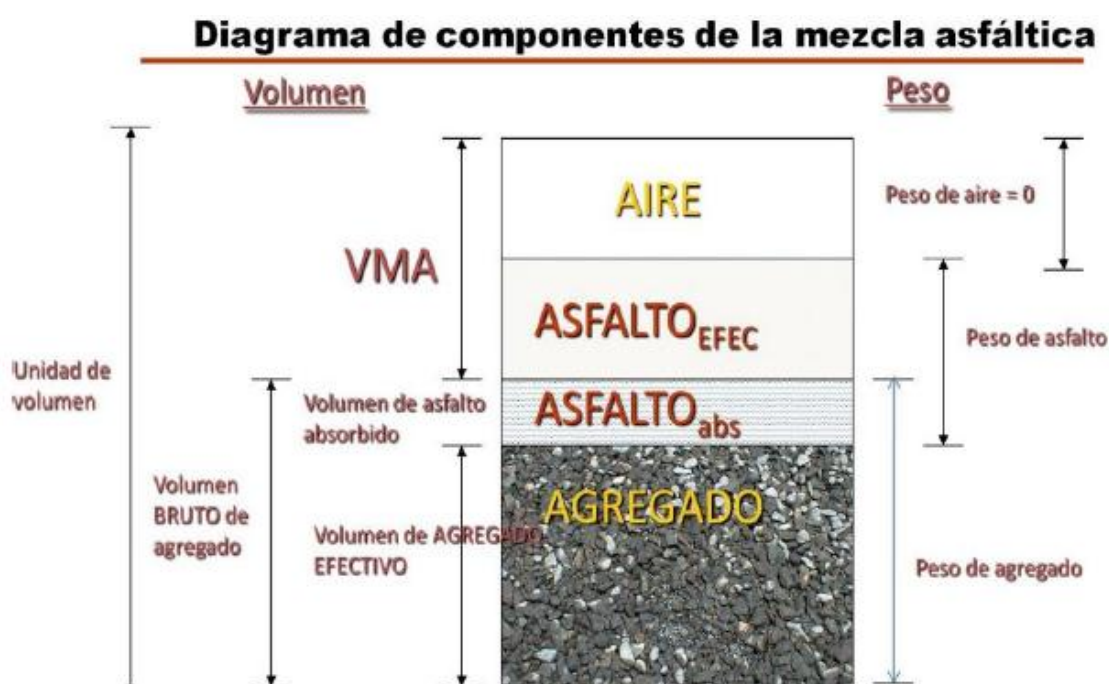
Figura 17. Componentes de la mezcla asfáltica
