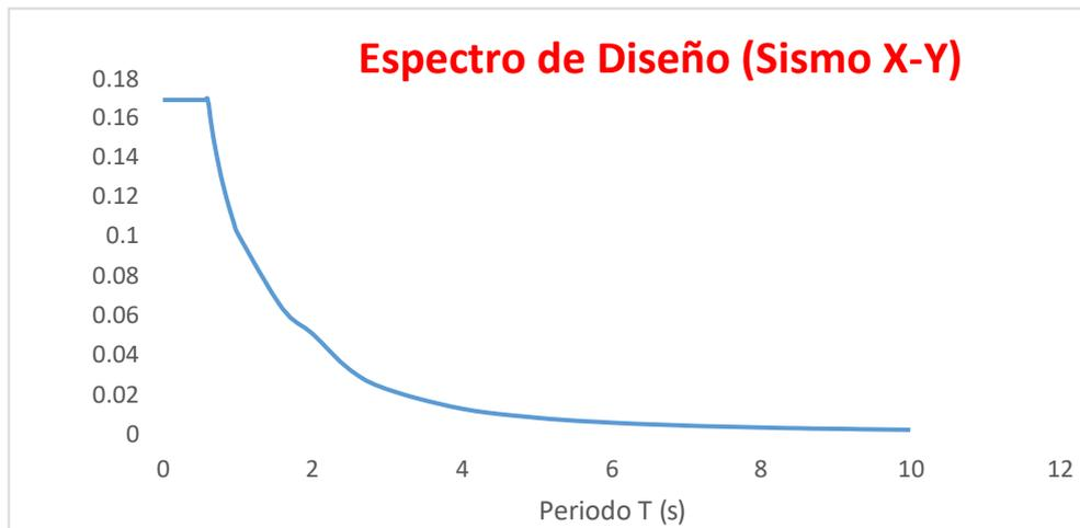
**Figura 20. Espectro de aceleraciones del edificio redimensionado**
