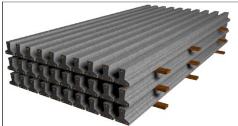
Figura 03: Correcto almacén de viguetas
