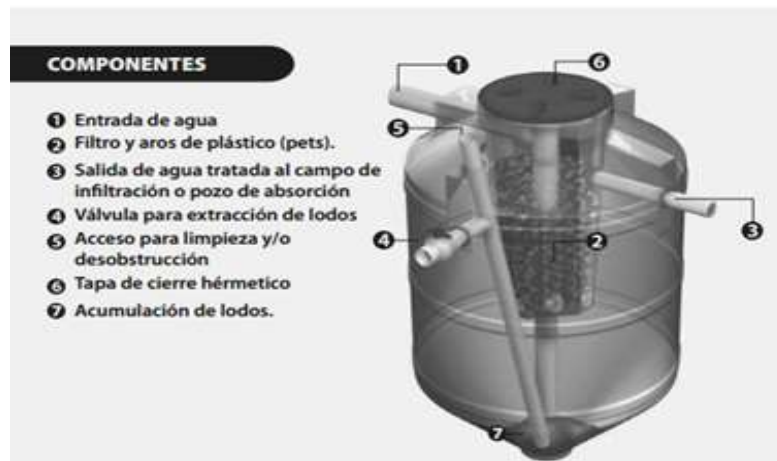
Figura .Componentes del biodigestor.
