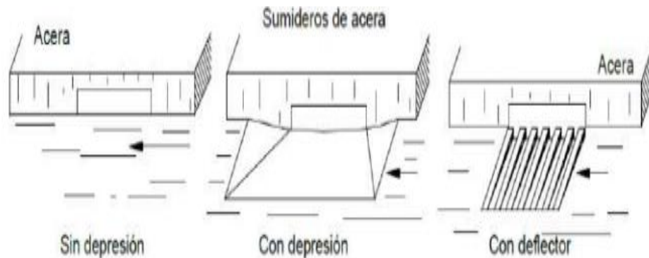
Figura 7. Sumideros laterales en sardinel o solera
