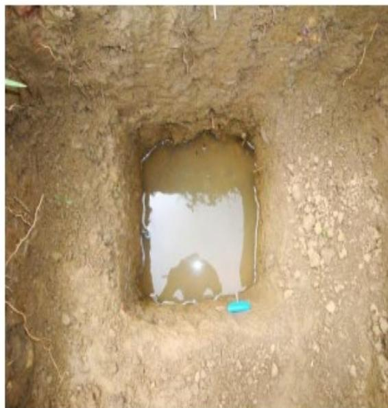
Infiltración en agujero de 0.30 x 0.30 y 0.60 m de profundidad
