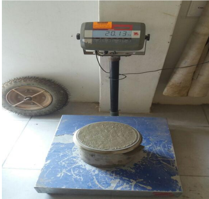
Anexo N° 24. Peso de la olla + el concreto.
