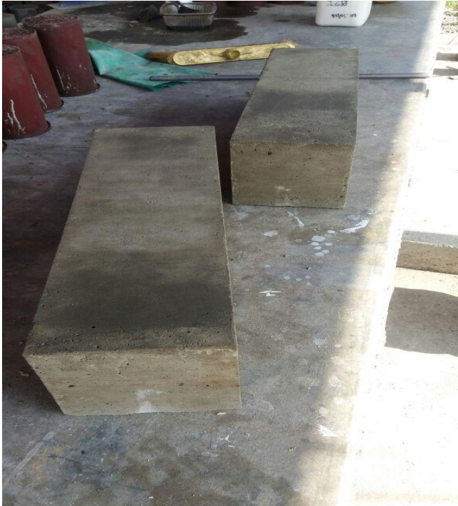
Anexo N° 28. Desencofrado de vigas.
