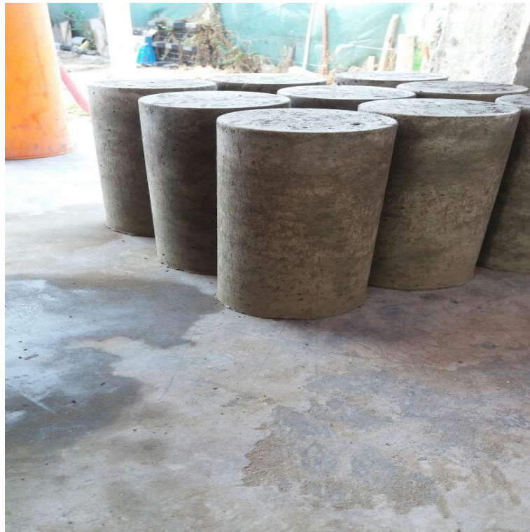
Anexo N° 27. Desencofrado de probetas.
