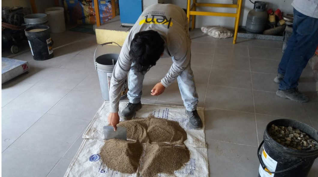
Anexo N° 6. Cuarteo del agregado fino.
