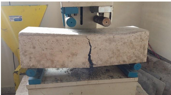
Figura 43. Ensayo de viga a resistencia a la flexotracción.
