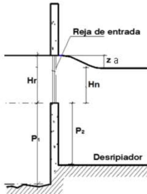
Figura N°03: Captación de toma lateral
