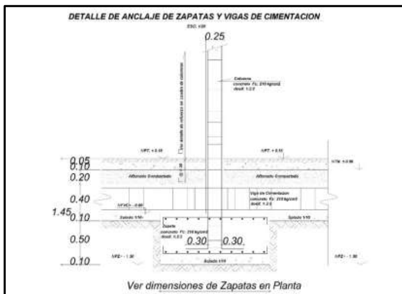
CORTE TIPICO DE ZAPATA
