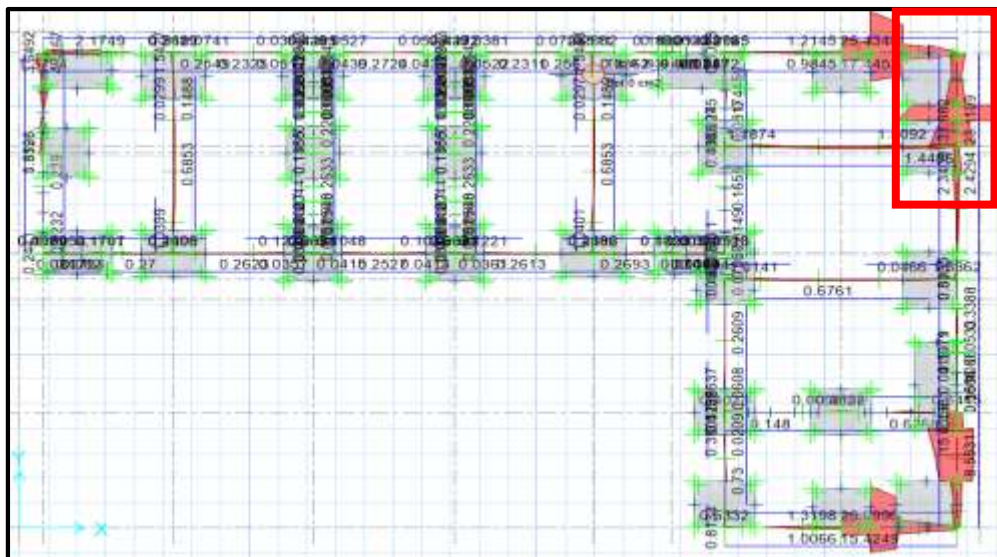
Cuantía de Acero en Vigas de Cimentación
