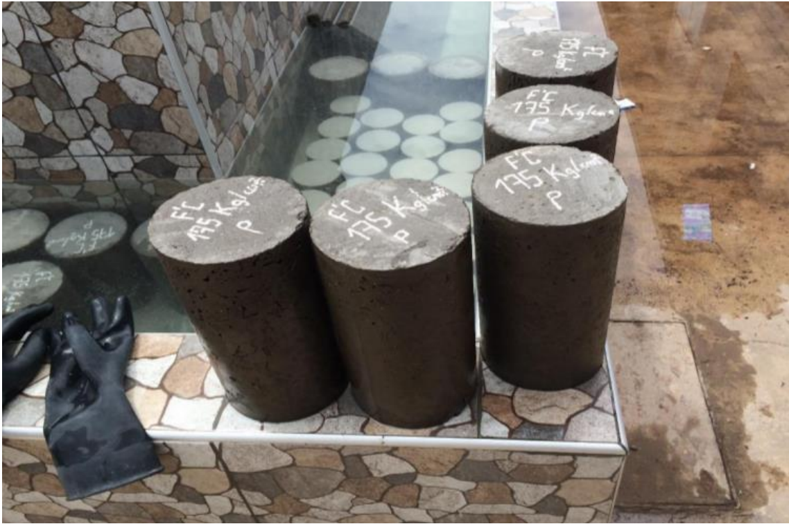
Fotografía 11. Sacado de briquetas para el ensayarlos a compresión
