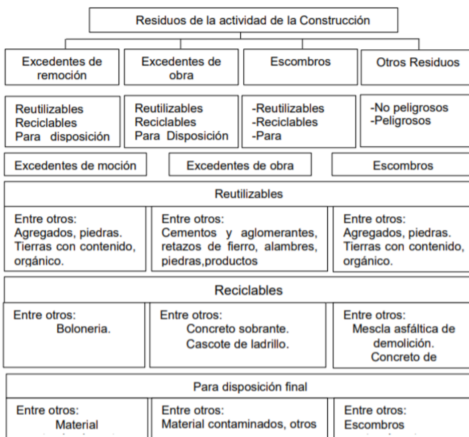
Figura 1. Esquema del manejo de residuos en actividades de construcciones
