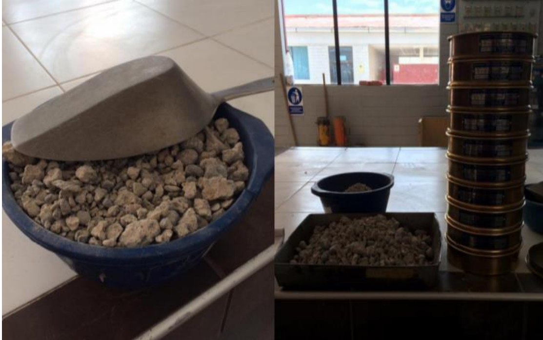
Fotografía 3. Muestra de árido reciclado a utilizar para el ensayo de la granulometría
