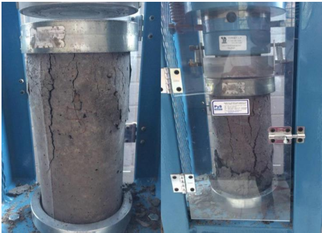
Fotografía 12. Rotura de briqueta
