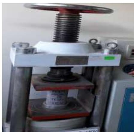
**Roturas a las compresiones de hormigón patrón**
