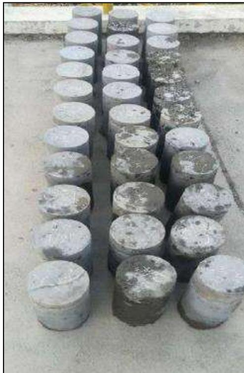
**Traslación y curados de probetas.**
