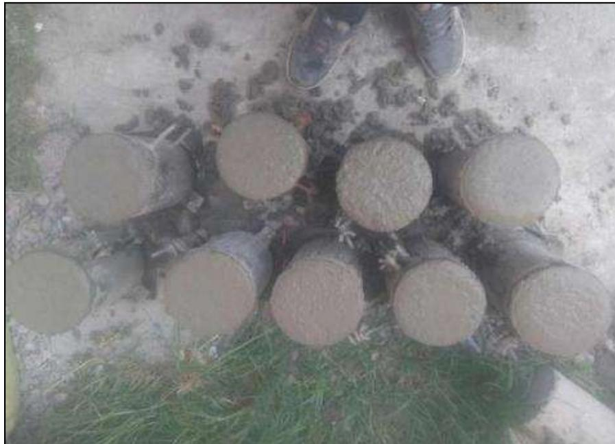
**Probetas preparadas para fraguados**
