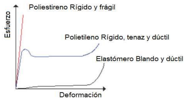
Figura 4.- Deformación vs. Esfuerzos en los poliestirenos.
