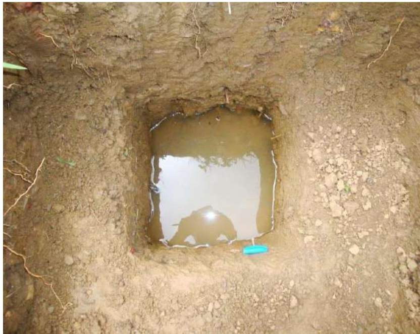
Infiltración en agujero de 0.30 x 0.30 y 0.60 m de profundidad
