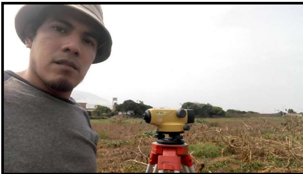
FOTO N° 3: Levantamiento con nivel de ingeniero para la verificación de niveles en la línea de conducción.
