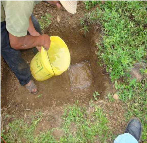
Llenado con agua para test.
