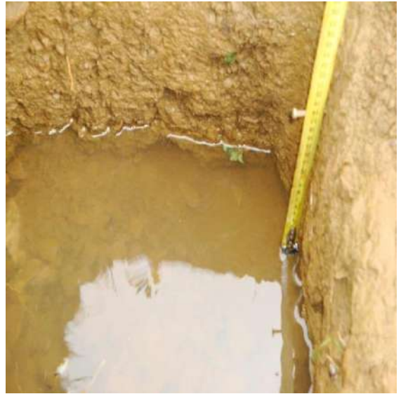
Lectura de infiltración en agujero de 0.30 x 0.30 y 1.0 m de profundidad
