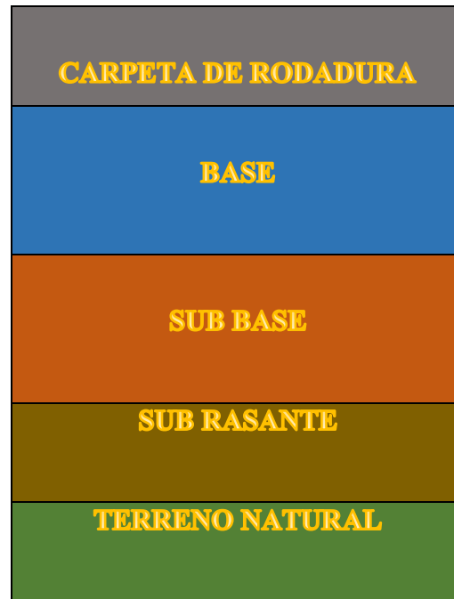
Figura 01. Elementos De Un Pavimento Flexible.
